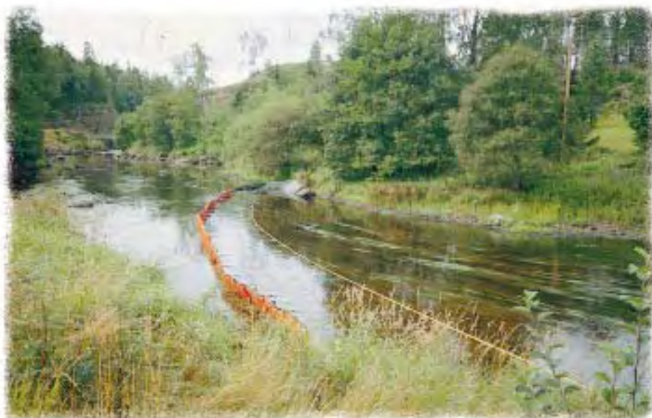
Styrning av olja i strömmande vatten.
