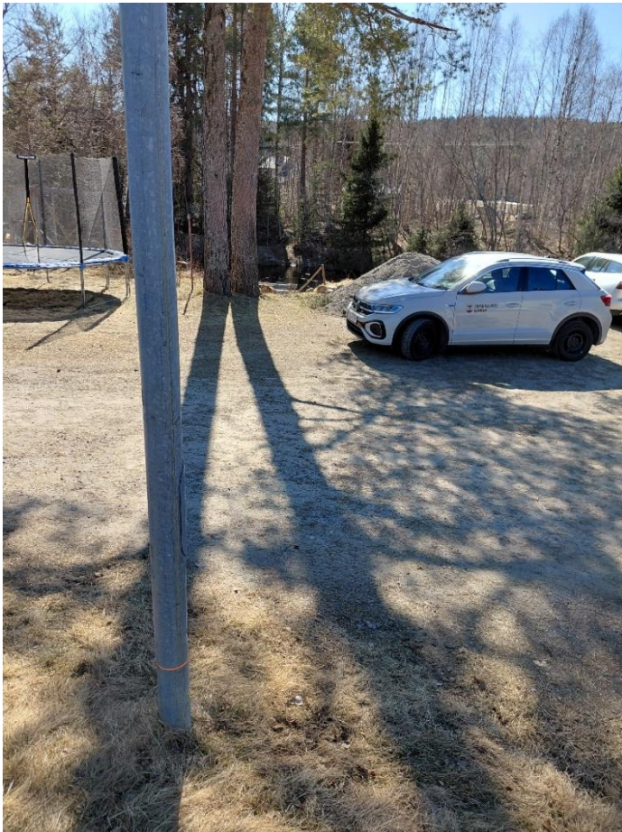
Det orangea strecket på stolpen visar den maximala vattennivån i Kubbe vid högflödet 20250909, strax uppströms bron över ån. I bakgrunden på fotot anas Norra Anundsjöån. Foto: Länsstyrelsen Västernorrland.
