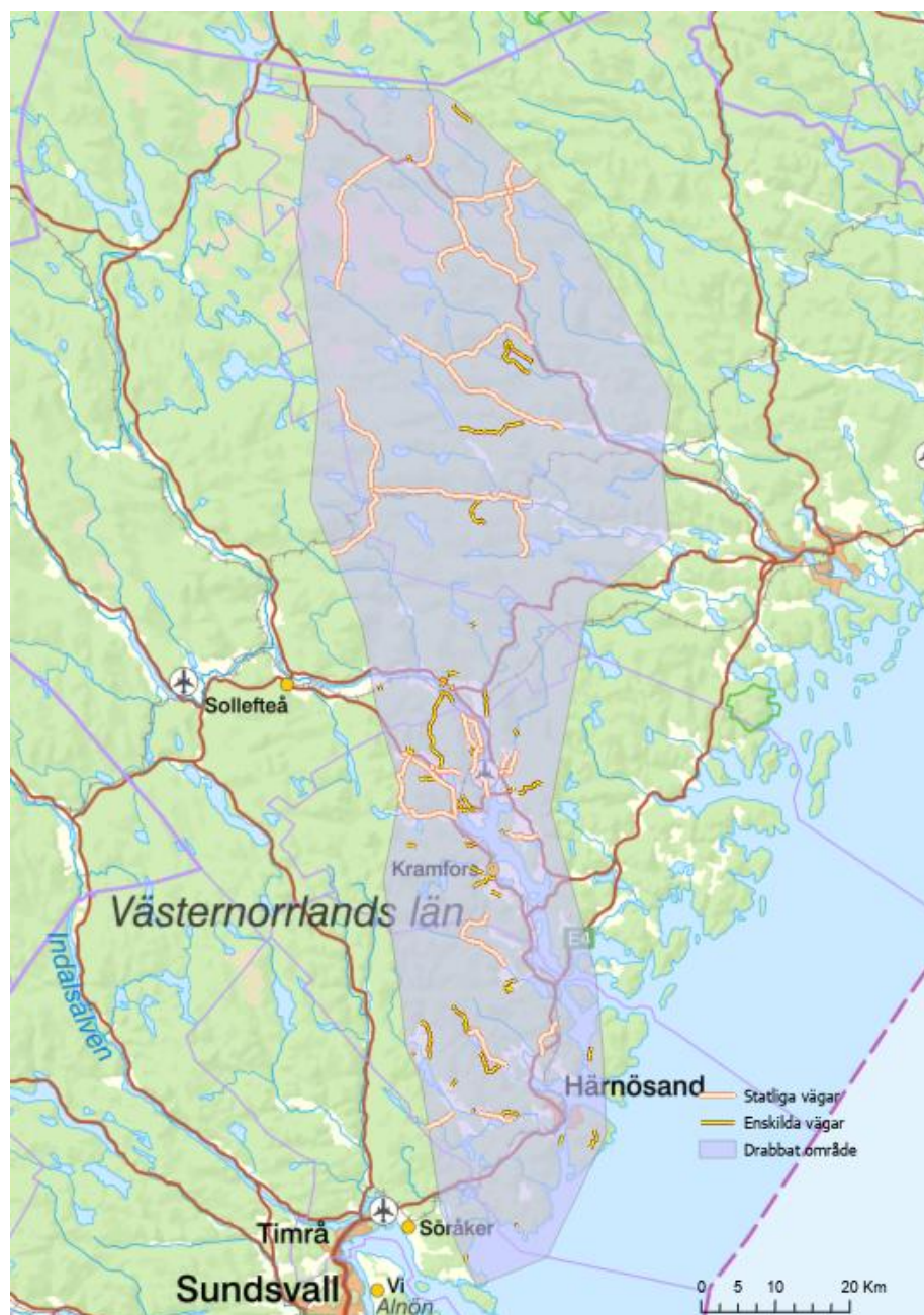
Figur 13: på kartan är de statliga vägsträckor som någon gång under händelsen var påverkade markerade. Vägsträckan kan ha varit helt avskuren eller varit påverkad med vatten på vägen. På kartan syns även de enskilda vägar som ansökt om statligt bidrag på grund av skador i samband med regnet, oavsett om det blivit beviljat eller inte. Källor: Lantmäteriet, Trafikverket och Länsstyrelsen.
