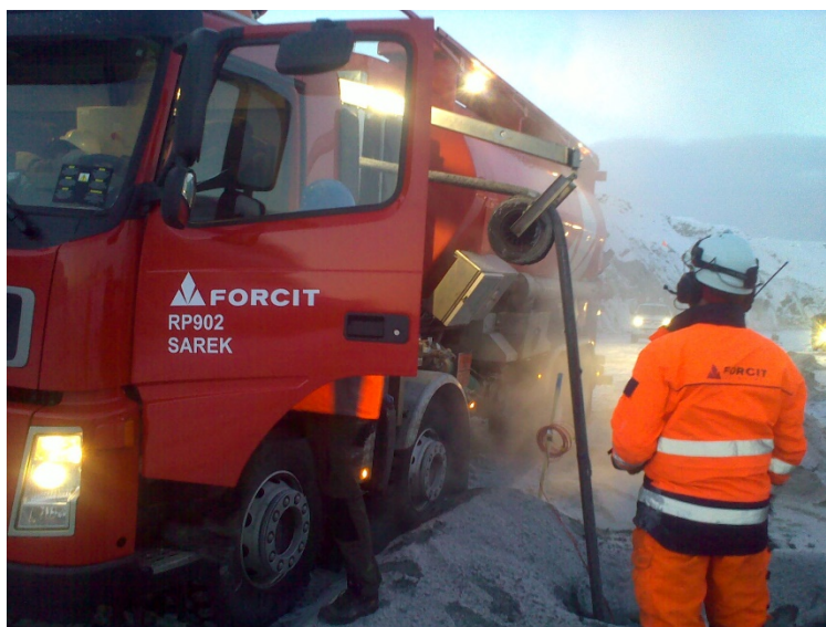
Bild 49: Laddtruck under arbete med mobil tillverkning av sprängämne. Foto: Forcitruck AB
