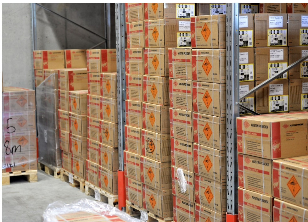
Bild 26: För att skydda de explosiva varorna bör de förvaras i sina transportförpackningar. Genom att låta kartongerna stå kvar på transportpallarna går det att få en luftspalt mellan varorna och förrådets golv. Foto: Rolf Weinander
