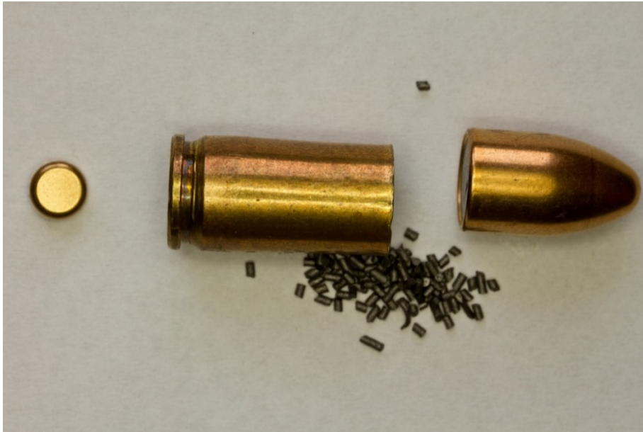
Bild 14: Komponenter i en patron. Foto: Ingemar Malmström
