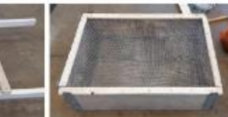
Bunn del med grovere armeringsduk (på hodet)
