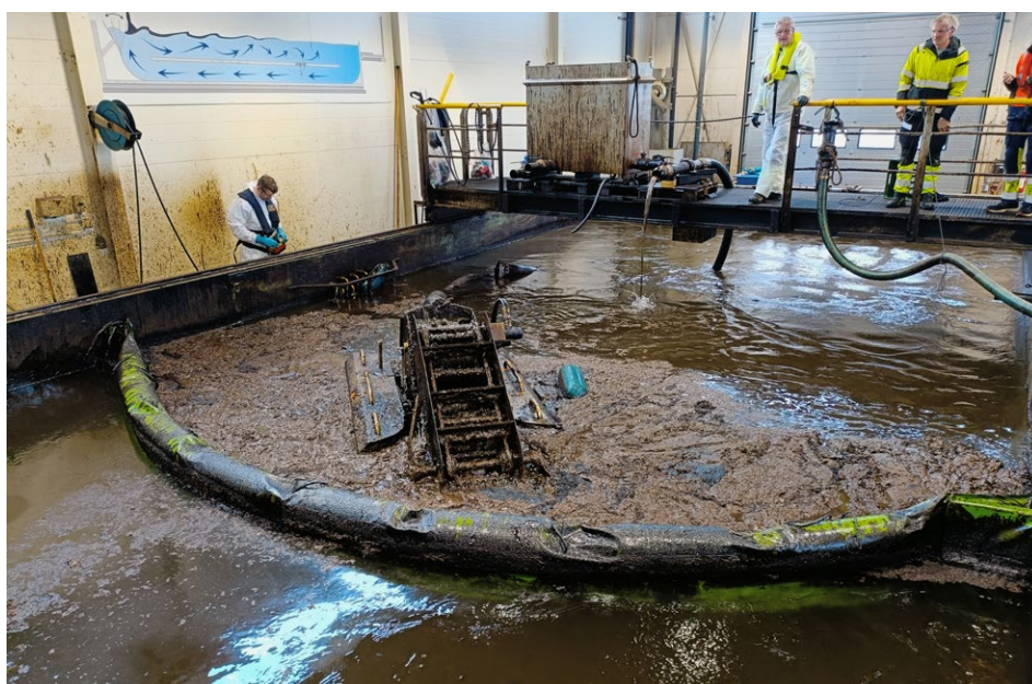
Test med oljeupptagare i en hybridolja, klassificerad som VLSFO vid norska Kystverkets anläggning i Horten, mars 2025. Foto: B Forsman.
