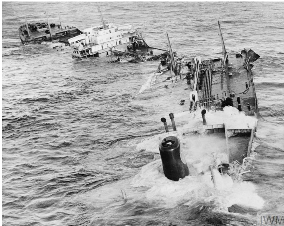
Tankfartyget Torrey Canyon byggt 1958 med dimensionerna längd L 267 m, bredd B 21 m och djupgående T 21 m, bröts itu vid grundstötningen och hela råoljelasten om 120 000 ton kom ut i havet. Foto: IWM (A 35082).
