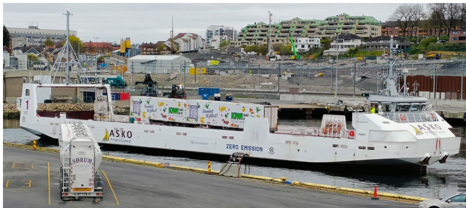
MS Marit, ett av två elektriska autonoma fartyg som transporterar trailers mellan Moss och Horten i Norge. Foto: B Forsman.
