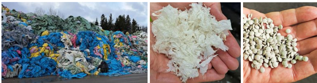
Bild 10: Insamlad plastmateriel som smälts om till plastråvara. Bild: SVA
