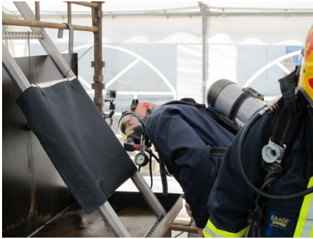
Figur 7. Branddräktsmaterial på stege för dämpning av utsläpp.
