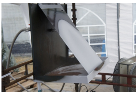
Figur 6. Plåt för dämpning av utsläpp.
