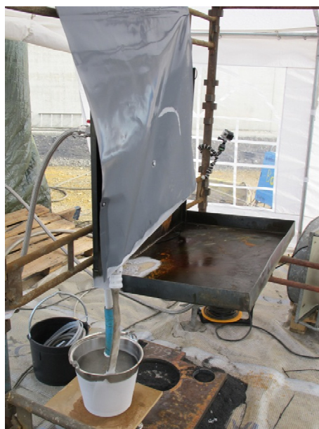
Figur 9. Presenning med uppsamlingsficka för dämpning av utsläpp.
