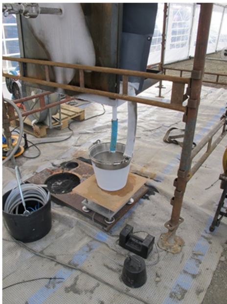
Figur 5. Hink på våg för uppsamling av impakterad vätska.
