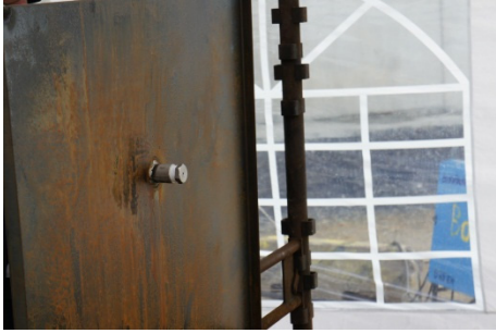
Figur 4. Munstycke för utspridning av ammoniak respektive svaveldioxid.
