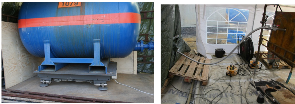
Figur 3. Tank med svaveldioxid placerad på väg (vänster). Slang mellan tank och munstycke (höger).
