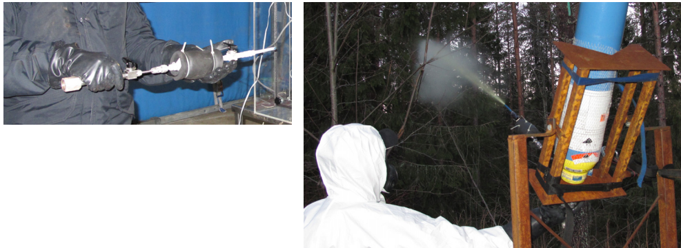
Figur 21. Till vänster ses behållaren som fylls med kondenserad gas. Till höger kylls behållaren först ner för att sedan fyllas med kemikalie.
