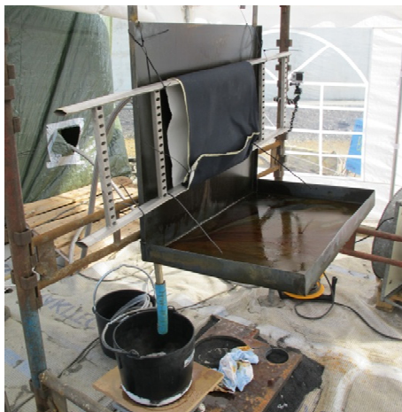
Figur 8. Branddräktsmaterial på stege för dämpning av utsläpp.
