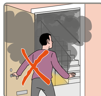
اگر در جای دیگری از ساختمان آتش‌سوزی پیش آمده است و در راه پله دود وجود دارد باید در آپارتمان خود باقی بمانید.
