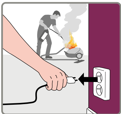
زمانی که دستگاه‌های الکتریکی آتش گرفته ابتدا سیم را از برق بکشید. آتش را با پتوی اطفای حریق یا مانند آن خفه کنید. با یک کپسول آتش‌نشانی پودری می‌توانید آتش را مستقیماً بدون بیرون کشیدن سیم برق انجام دهید.
