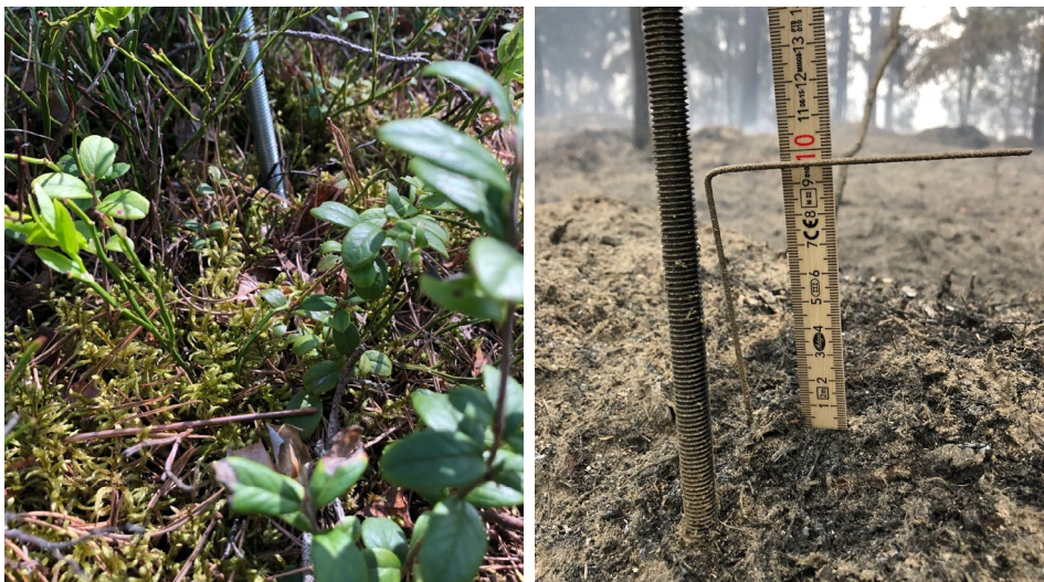
Figur 2. 90-graders vinklad stålpinne för uppskattning av avbränt djup. Till vänster: Stålpinnens position i obränd mark. Till höger: Stålpinnens position i bränd mark. Bränsledjupet uppmättes som avståndet från den brända marken till den ursprungliga höjden för mossans övre del.
