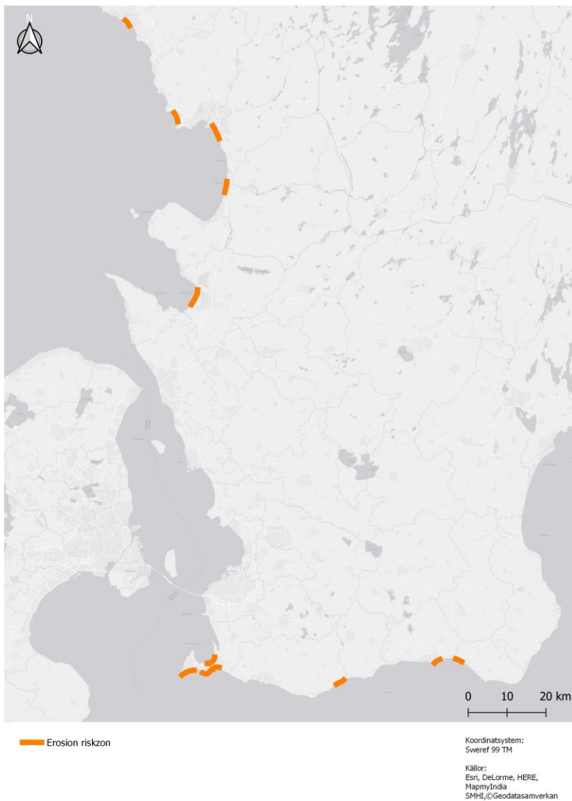
Figur 5-1 Preliminär bedömning av kuststräckor där erosion under stormar kan leda till översvämnning.
