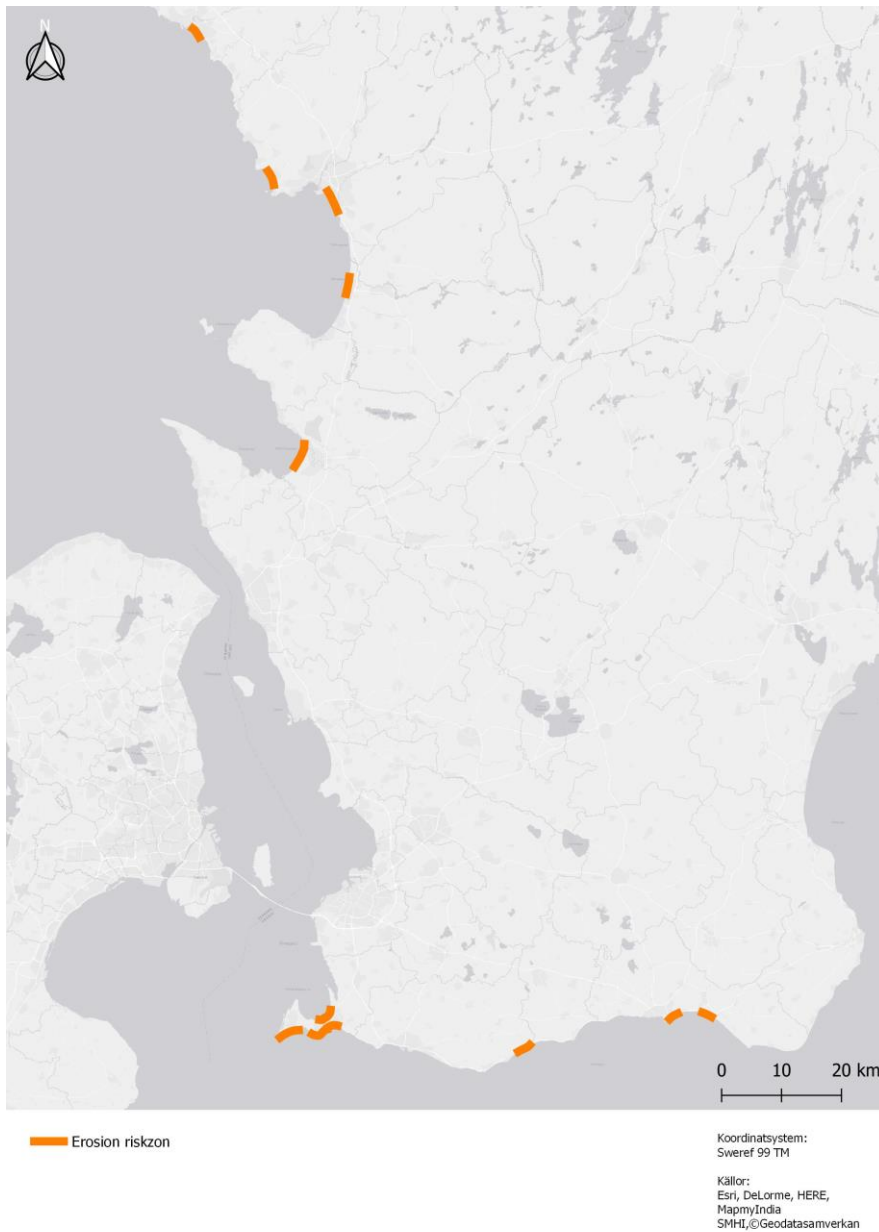
Figur 4-5 Kuststräckor där erosion under stormar kan leda till översvämning.
