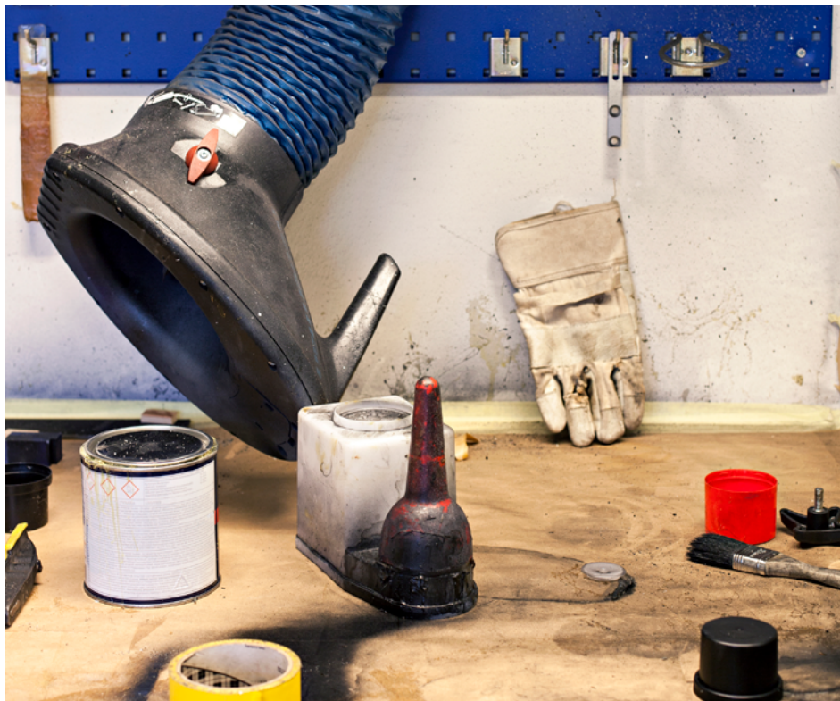
Ett lokalt punktutsug kan man använda för att ventileratrymmet bort brandfarliga ångor. Foto: Johnér Bildbyrå/ Ulrika Kestere.
