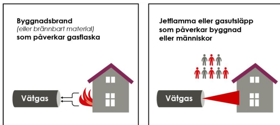
Figur 3. Säkerhetsavstånd ska skydda från en brand i omgivningen och en olycka på gasanläggningen
