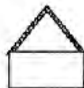
Princip för utformning av värmeisoleringen i tak. Varianten t h kallas massivtak och används när vinden skall inredas. Vindtäthet hos värmeisoleringen är i både fallen en väsentlig egenskap.
