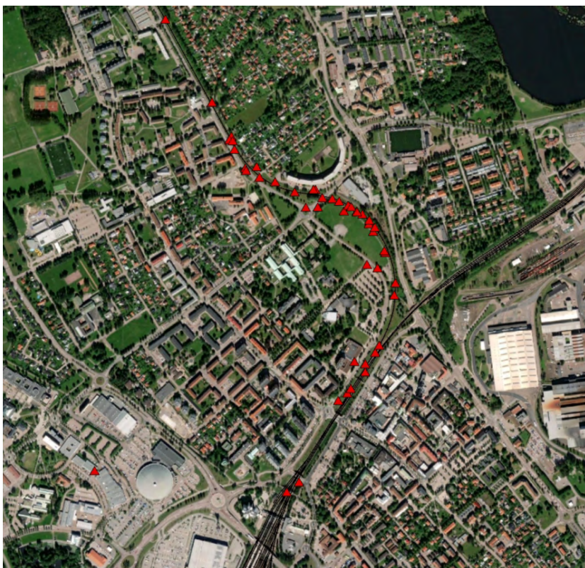
Figur 14. Rapporterade tågbränsbränder längs en kurva på spåret där tåget förväntas att bromsa in.
