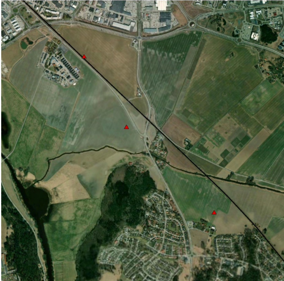
Figur 12. De röda punkterna är rapporterade tågbränsbränder. Bara en av de tre punkterna har angivna koordinater som ligger inom 50 m av tågspåret (svart linje).
