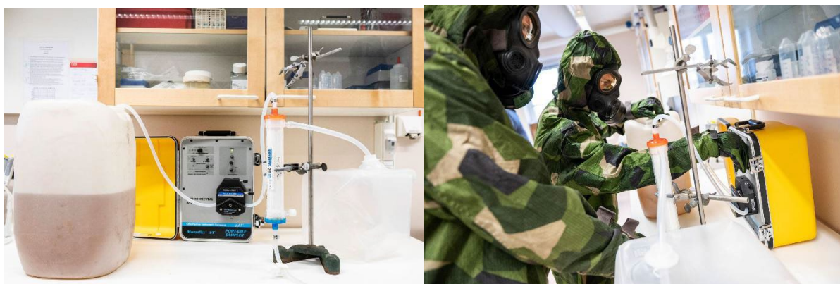
Bild 7. Till vänster visas provtagningsutrustningen för ultrafiltrering uppsatt. Bäckvattnet från dunken pumpas genom ultrafiltret med en portabel peristaltisk pump, som vid provtagning i fält kan drivas av till exempel ett bilbatteri. Högra bilden visar när två personer ur 1. CBRN kompaniet, iförda skyddsutrustning, sätter ihop utrustningen och genomför provtagningen.
