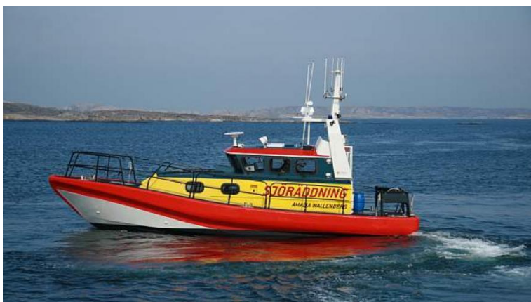
Figur 26. Rescue Amalia Wallenberg är den modernaste och snabbaste av SSRSs enheter i Vättern med en maskineffekt av 900 hk som ger den fartresurser upp till 34 knop och en aktionstid av 10 timmar.
