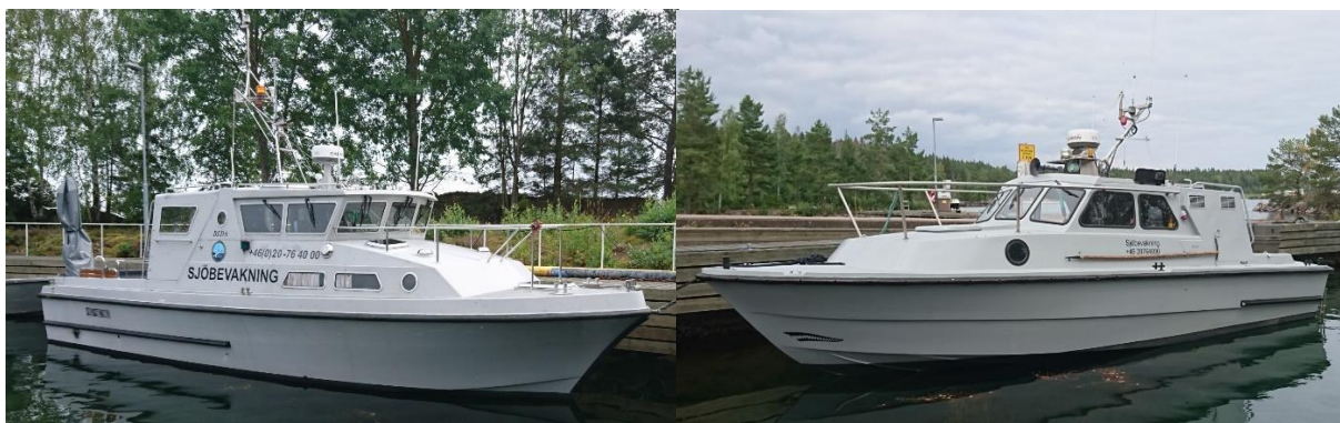
Figur 27. FMVs båtar i Karlsborg, båten till vänster har längd L 10,5 m och en motoreffekt av 450 hk och båten till höger har längd L 8,4 m och en motoreffekt på 460 hk.
