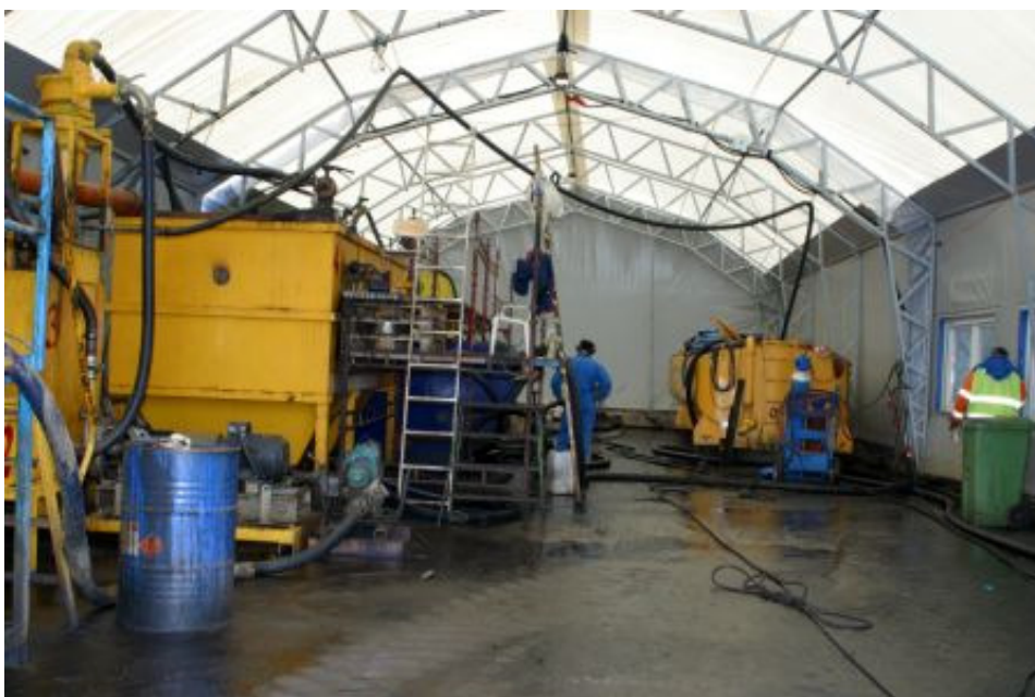
Figur 3.9. Vägverket Produktions anläggning för jord/sandtvätt i Ystad.
