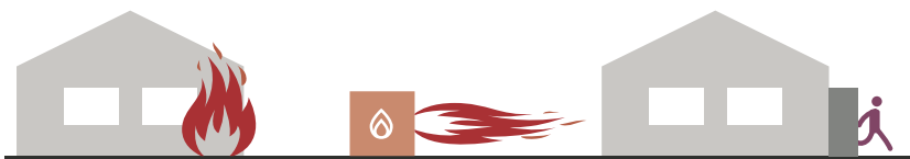
Figur 18. Schematisk illustration av risk för skadlig uppvärmning av ett gaslager och utrymning av närliggande lokaler.
