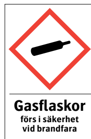
Figur 9. Varningsskylt för gas under tryck med tilläggs-texten ”Gasflaskor förs i säkerhet vid brandfara” 10
