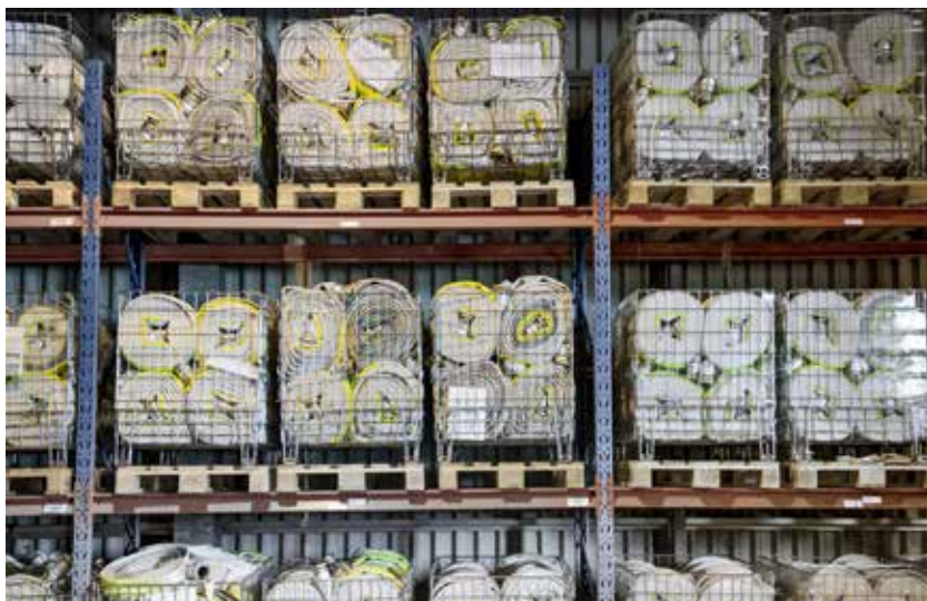
Brandslangar på MSB:s lager i Kristinehamn. En skogsbrandsdepå består av tre containrar som bland annat innehåller drygt 23 km slang. Foto: Pavel Koubek.
