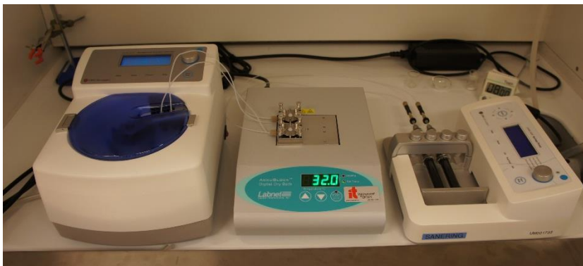
Figur 2. Försöksupställning under hudpenetrationsexperiment. Från vänster till höger ses fraktionssamlare, diffusionsceller på värmeblock och sprutpump.
