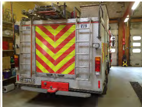
Bild 34, Inga reflexer bak då skåp är öppet, endast en blålampa bak.
