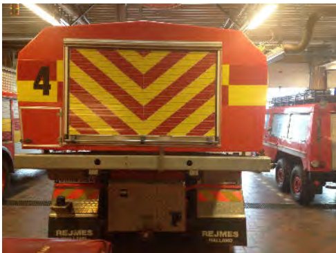
Bild 33, Endast en lågt placerad blålampa bak
