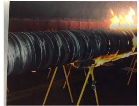
Bild 2. Brand efter fem minuters provning Källa: Räddningsverket (2005)
