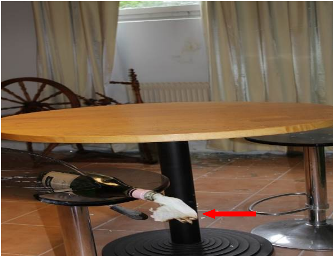
Bild 11. Man kan tydligt se att man har tänt på trasan vid flaskhalsen.
