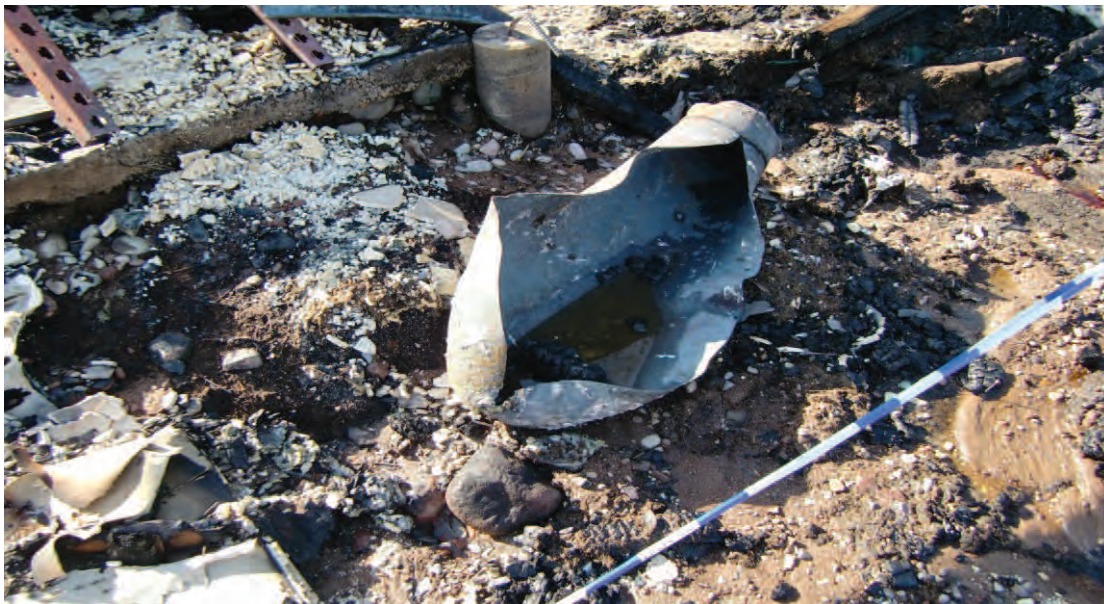
Bild 2. visar gasflaskan som sprängts innan räddningstjänsten kom till platsen
