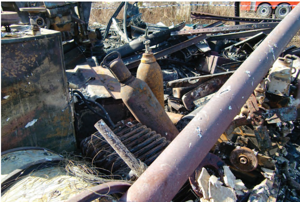
Bild 4 två av gasflaskorna i branden.
