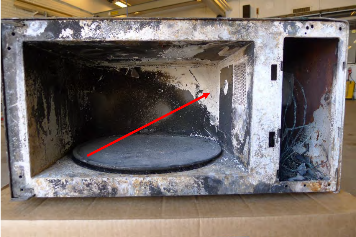
Bild 2. Pilen markerar bortbränd yta utan sotavsättning
