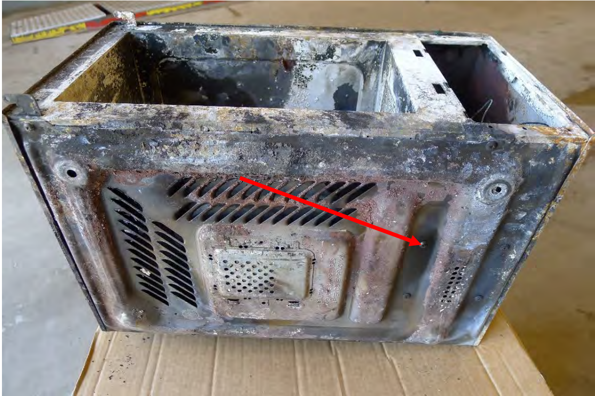
Bild.6 – 7 Plåtbotten av stål vilken varit starkt uppvärmd. Pilen visa blåanlöpning
