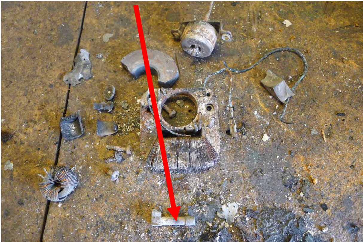
Bild 13. Intern i mikron placerad glassäkring (Undersökt i mikroskop) Samt delar till fläktmotor.
