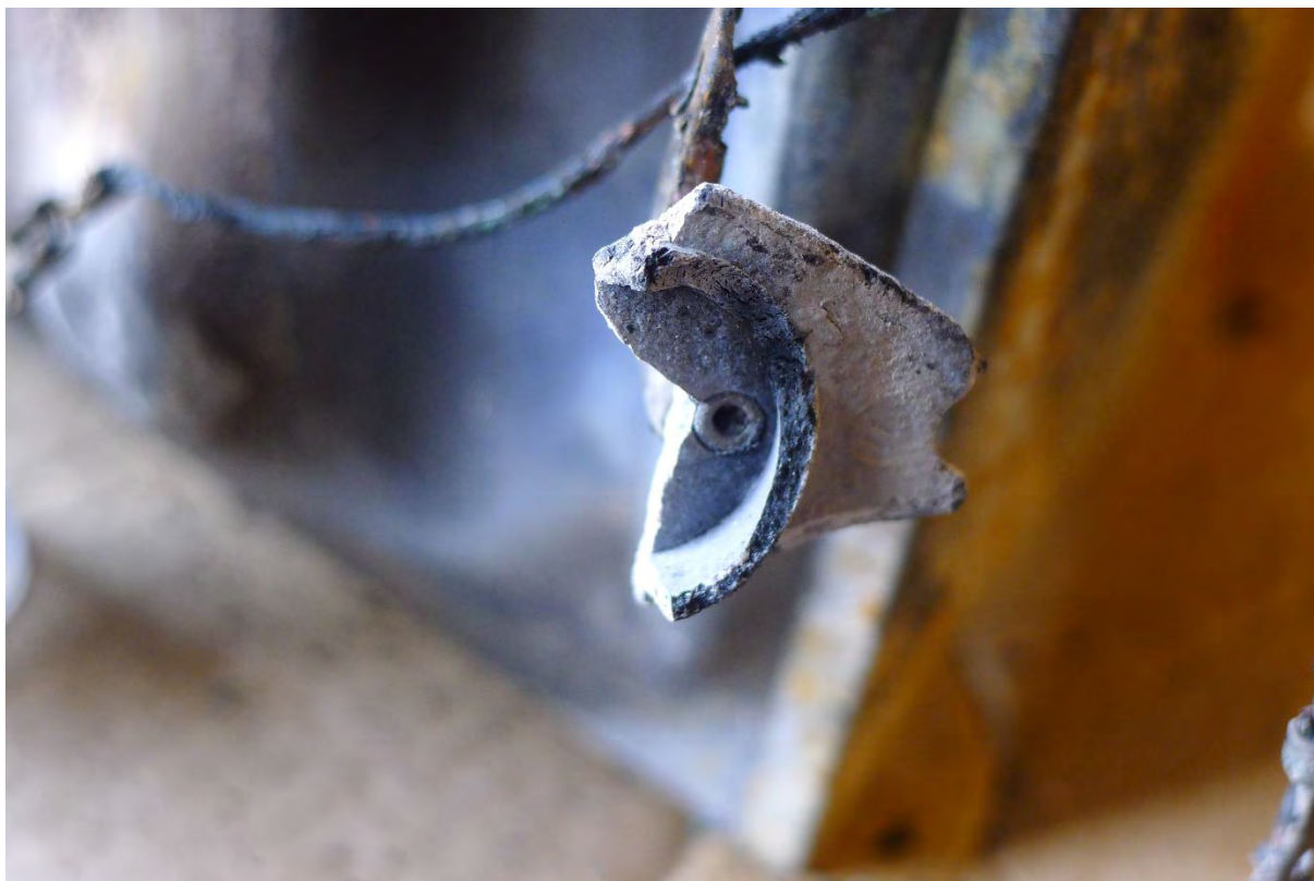
Bild 10. Lamphållare av porslin till den invändiga lampan i mikron
