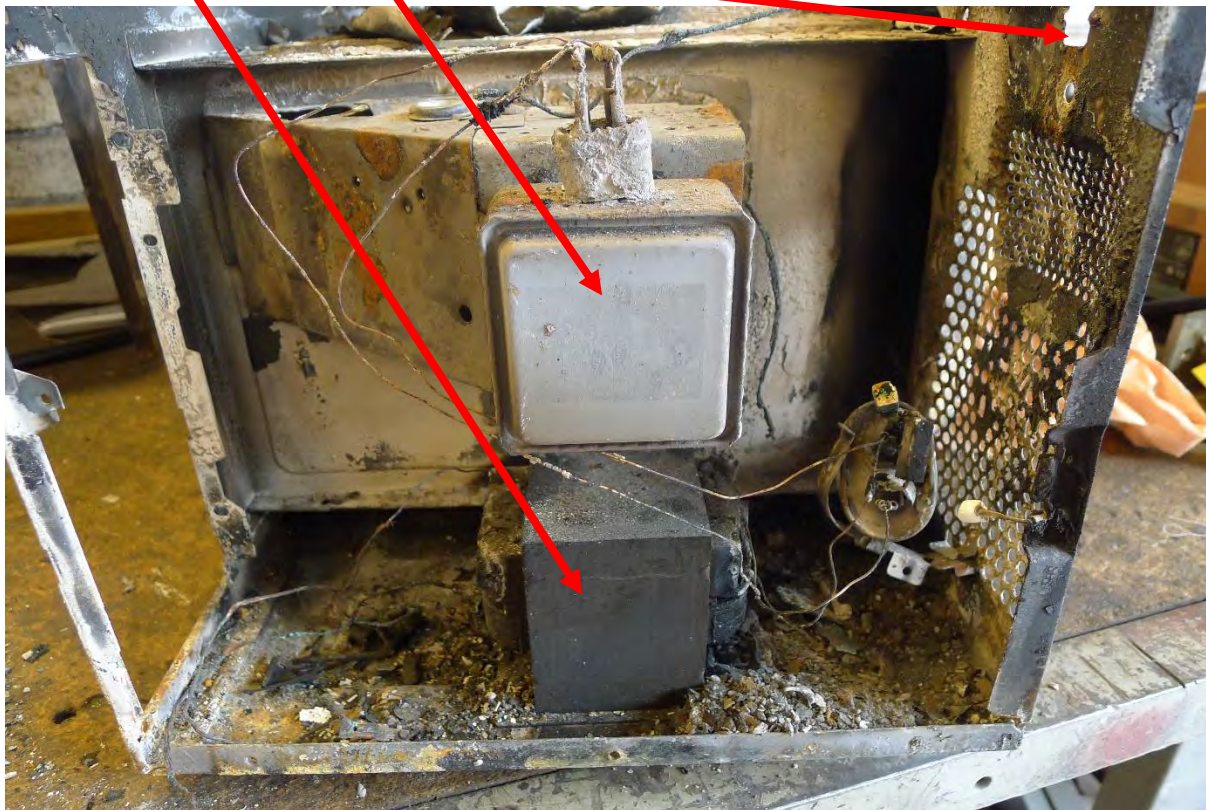
Bild 12. Kretskortets placering är inom blått område, pilformen visar återfunnet fragment av kortet.
