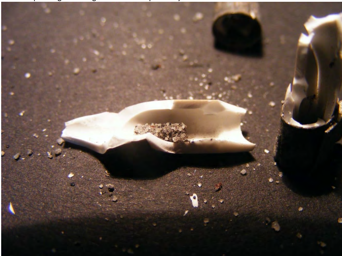
Bild 16. Spräckt glassäkring med sotskada på brottyta
