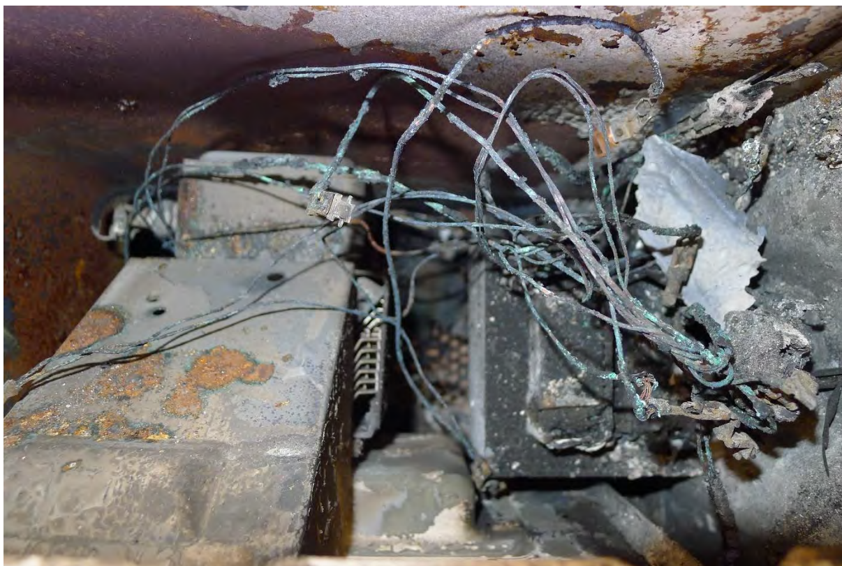
Bild 10. Lamphållare av porslin till den invändiga lampan i mikron
