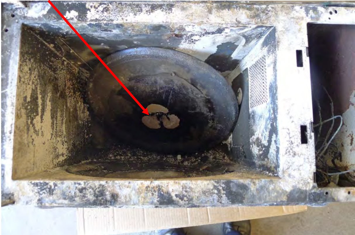
Bild 8. Plastsålta under den glastallrik som tillhör tillagningsutrymme
