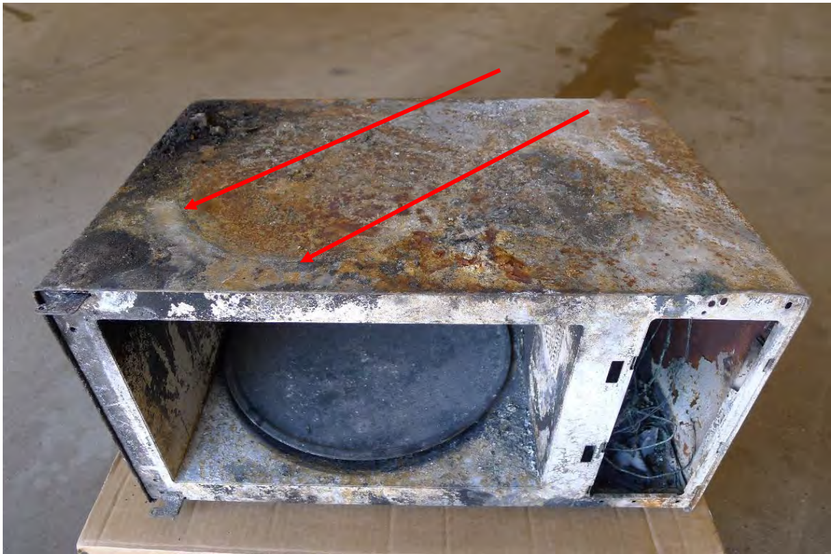
Bild 1. Del av kontur som bildats från stekpanna som stod på mikro vid branden
