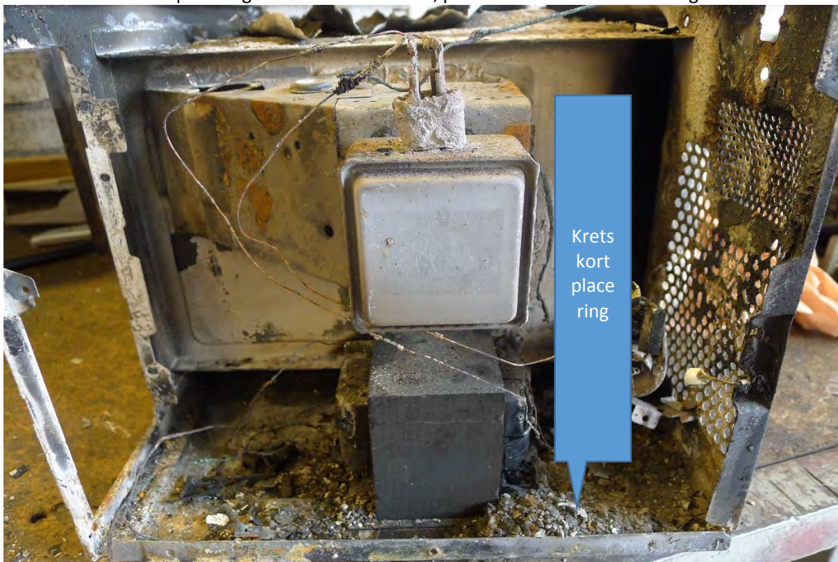
Bild 12. Kretskortets placering är inom blått område, pilformen visar återfunnet fragment av kortet.
