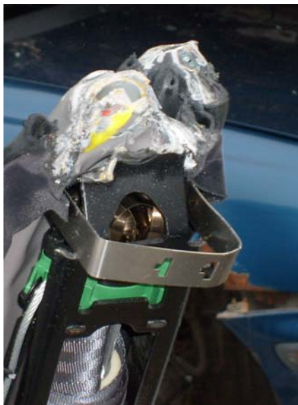
Foto som tagits i efterhand där man tydligt kan se gängorna i stolpen i vilka bulten suttit.
