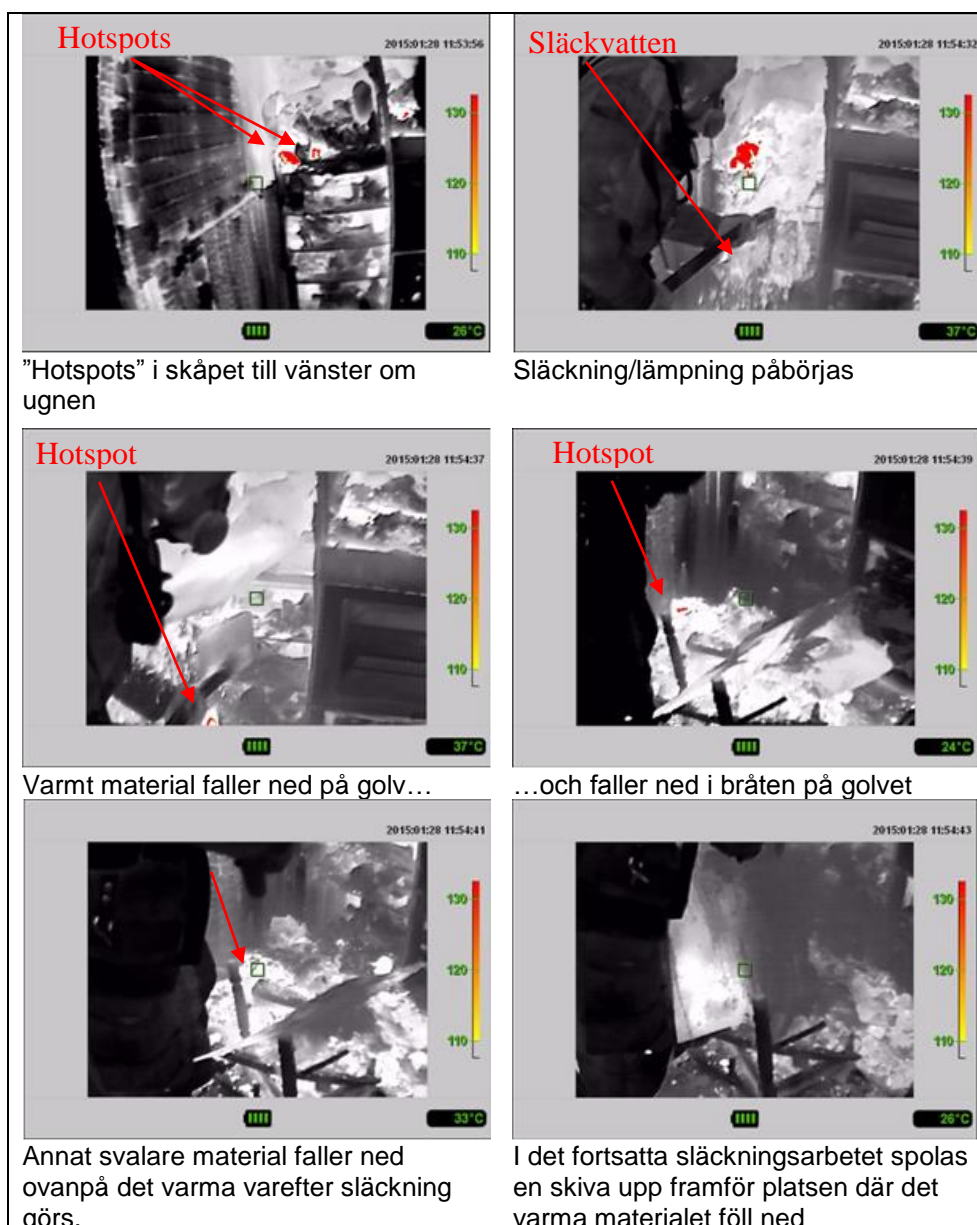
Figur 21: Bildsekvens från värmekamera där det framgår att varmt material, i samband med släckning, föll ned i bråten på golvet.
