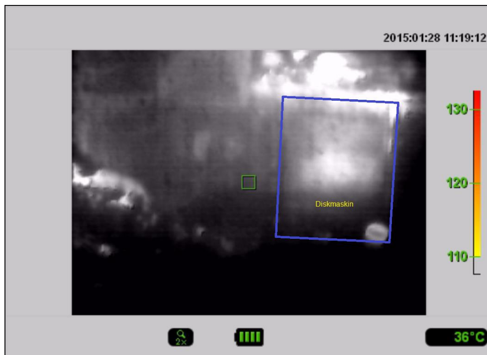
Figur 15: Bildruta från värmekameran som visar att relativt höga temperaturer återfinns i anslutning till diskmaskinen i köket (10:08:30).
