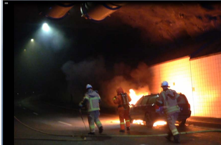
Bild 5. Det var frisk miljö bakom bilen, men svart tjock rök framför den brinnande bilen i färdriktningen. Överst i bild kan man se en del av fläktarna som styrs med automatik när brandlarm utlösts.
