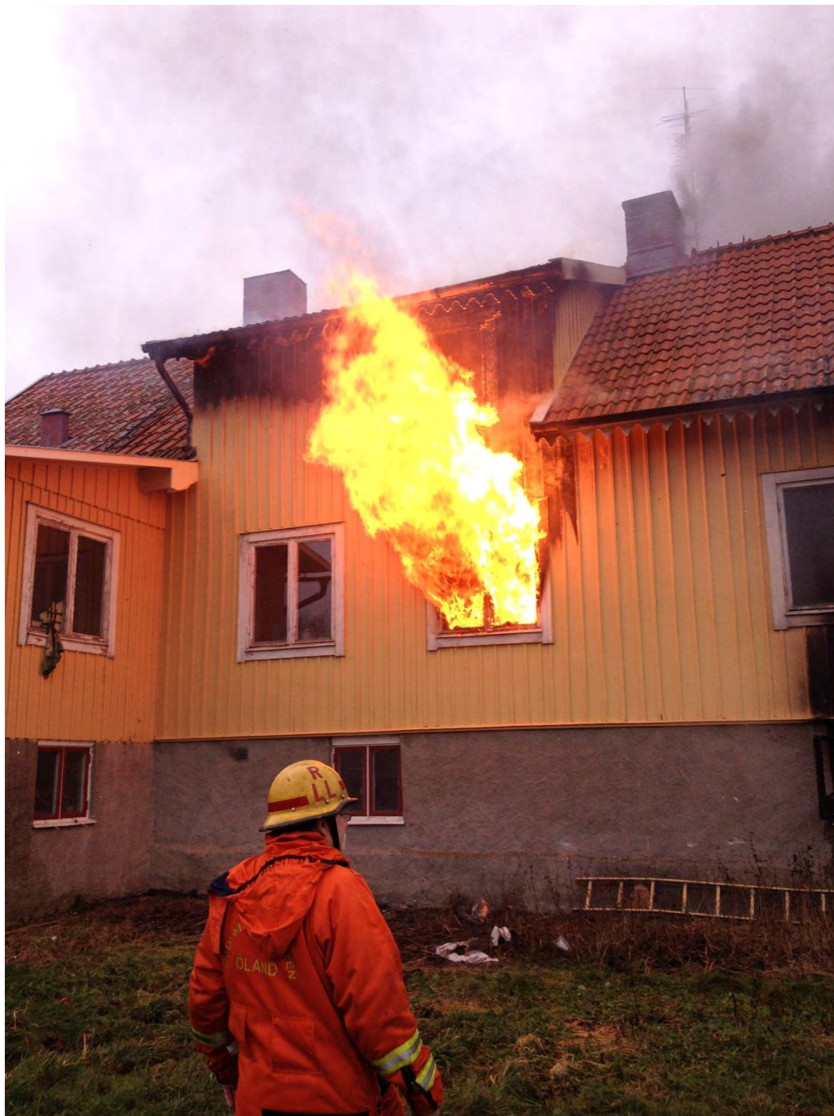
Bild 2. Byggnaden sedd från baksidan när övertändningen på bottenvåningen kom.
