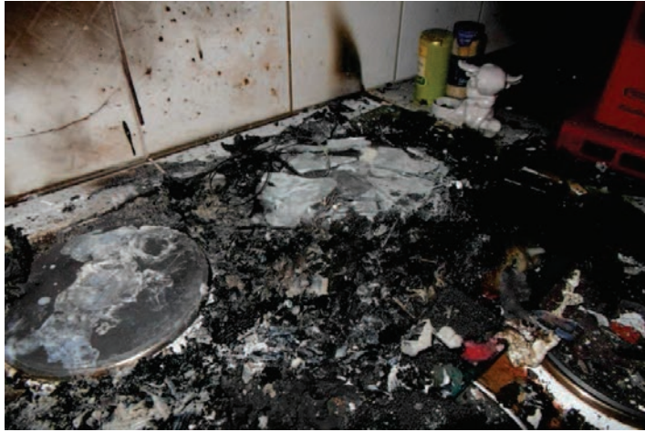
Figur 3, Spisplattorna, som var varma när räddningstjänsten anlände ca 09:25
