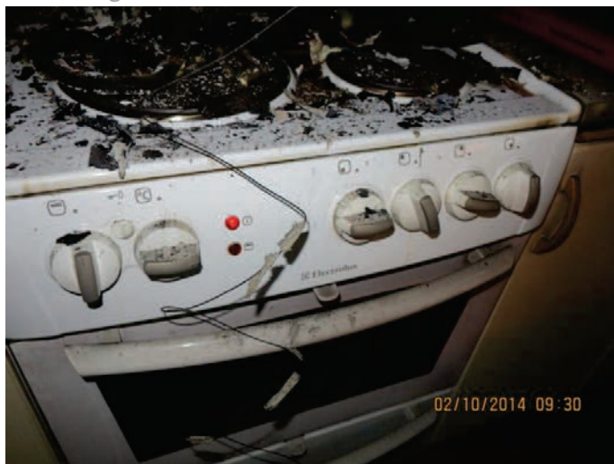
Figur 1, Spisvredens läge vid rökdykarnas ankomst, två plattor var varma
