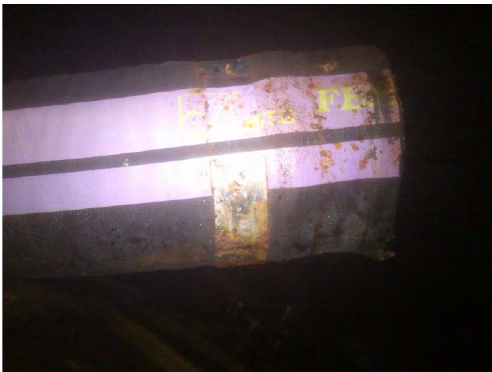
Bild 3: Visar den ända av påfyllningsslangen som släppte från påfyllningsröret till cisternen. Tecken på påfyllningsslangen visar att den hållits på plats av två slangkopplingar.
