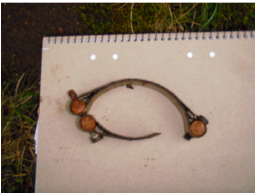
Bild 4: Visar en del av den sönderfräta slangkopplingen som hållit påfyllningsslangen på plats
