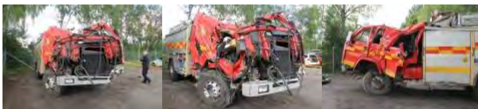
Figur 11 Bilder som visar hur hytten på brandbilen har deformerats.
