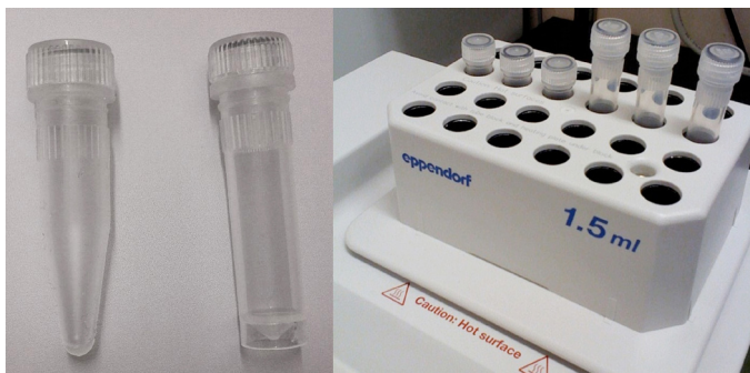
Figur 3. Inkubering av rör i värmeblock. Vänstra bilden visar ett 1,5 mL och ett 2 mL skruvlöcksrör. I högra bilden är tre rör av varje sort placerade i ett värmeblock (termomixer). De större rören (2 mL) sticker upp ur blocket och bakterier som fastnat på rörets väggar undgår hettan från blocket. Risken är därför stor att levande bakterier finns kvar i röret även efter en längre tids värmebehandling (>30 min).
