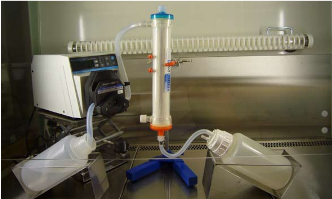
Figur 8. Backflush då elueringslösning (vänstra flaskan) pumpas genom filtret för att eluera ut mikroorganismerna till uppsamlingsflaskan (till höger). Metallställen har tillverkats av SVAs verkstad för att passa till dessa flaskor. När flaskorna läggs ned på det här sättet behöver inte filtret vara lika högt upp som om flaskorna står upp. På så sätt blir hela uppsättningen enklare att arbeta med inne i bänken. För att förhindra stänk och aerosolbildning används ett lock med slanggångor där utloppsslangen fästs in. Arbetet sker i säkerhetsbänk.
