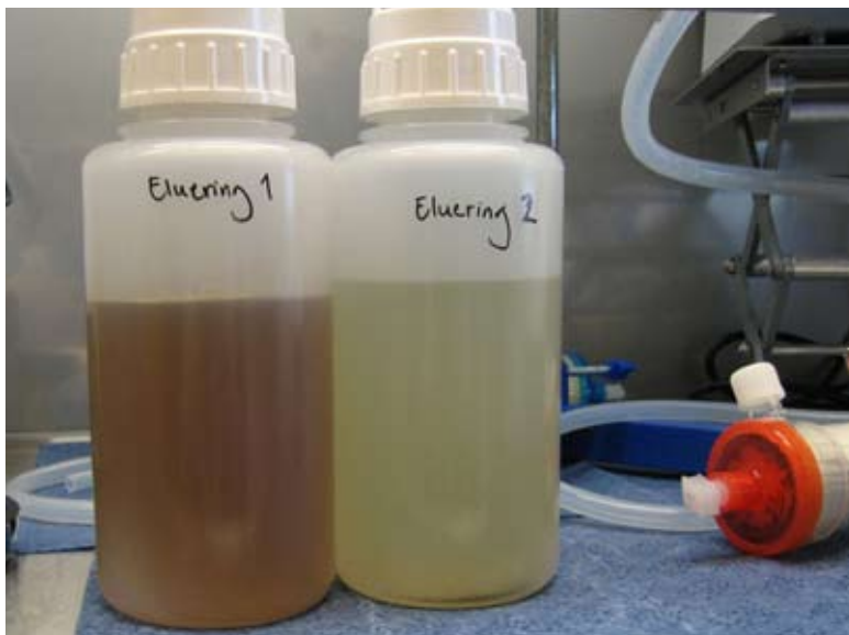
Figur 13. Eluat från två platser i rekreationsområdet där vatten provtogs under fältförsöket (rubrik 6 ovan), vilka visar hur olika karaktär två färskvattenprover kan ha. I bakgrunden till höger syns ett ultrafilter där en hel del större partiklar från vattnet fastnat i filtrets topp, under den brandgula platen.
