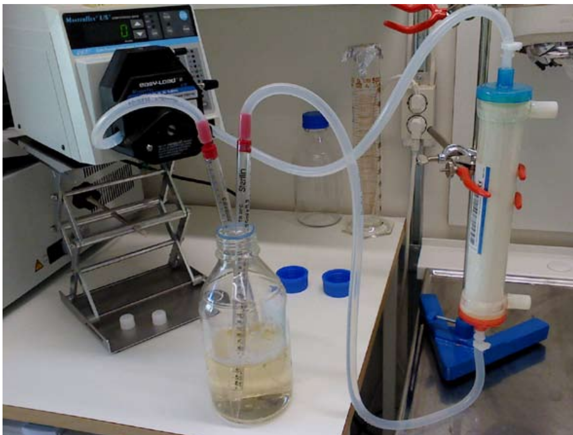
Figur 6. Förbehandling där kalvserum cirkuleras genom filtret under 5 minuter, varpå filtret korkas igen och läggs på vippbord i rumstemperatur 2-20 h.
