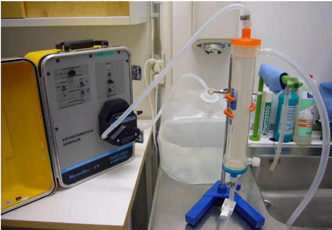
Figur 7. Dead end- ultrafiltrering av 20 L kranvatten spikat med B. cereus sporer och F. tularensis .
