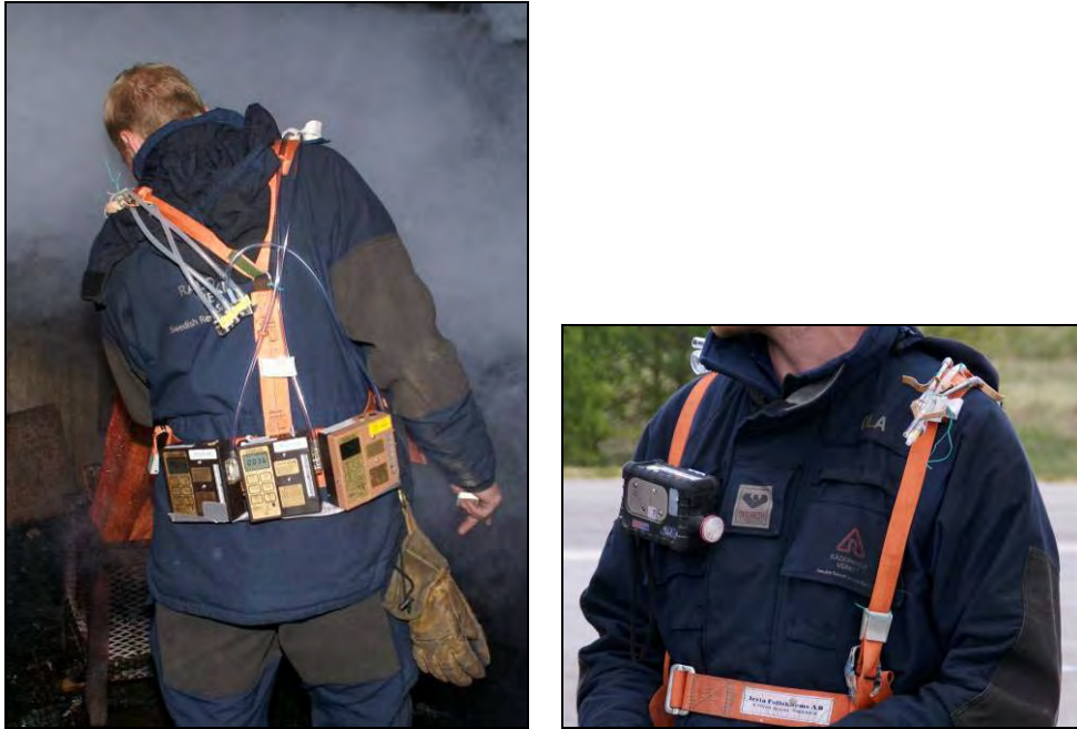
Figur 11; Instruktor i arbete, med kroppsburen mätutrustning, till vänster inne i övningsanordning i samband med initiering av övning och till höger utanför övningsanordning under övningens genomförande..
