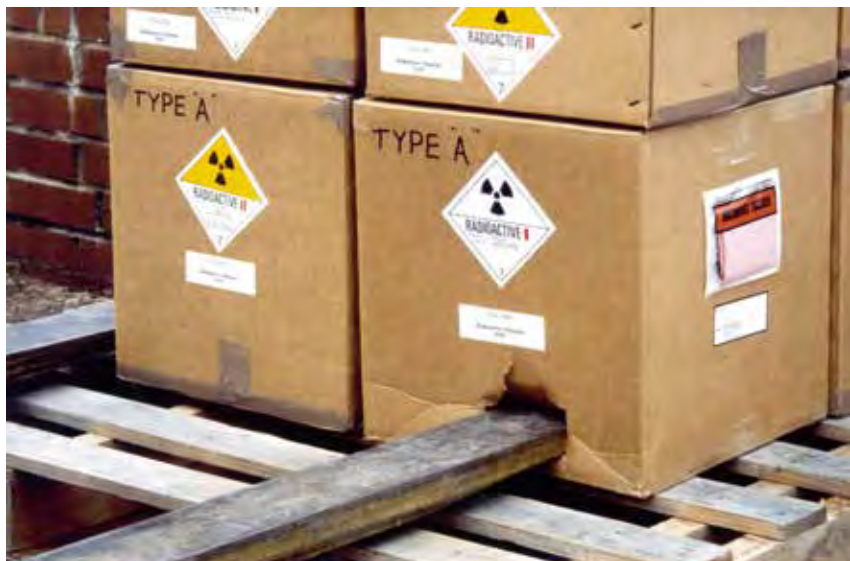
Kolli skadat av gaffeltruck. Foto: IAEA.
