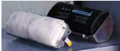
Krockkuddar läggs alltid med kudden/stoppningen uppåt
