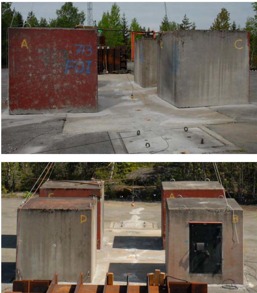
Figur 2.3 Foto på försöksuppställning. Övre fotot visar en laddning på 0,4 kg (orange sfär) placerat i läge #3 på höjden 0,20 m medan undre fotot visar en 1,6 kg laddning placerad i läge #4 på höjden 1,15m.
