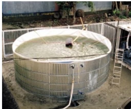
Vid översvämningen i Bangladesh ställde Räddningsverket i ordning ett reningsverk, som förvandlade det smutsiga flodvattnet till dricksvatten åt minst 3000 familjer.
