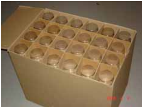
Figur 2 Standardgods bestående av polystyrenmuggar i wellpappkartong. Till vänster det standardgods som används vid sprinklerprovningar. Till höger det standardgods som användes i detta projekt.
