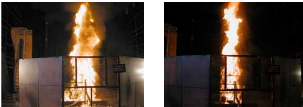
Figur 16 Brand med varierande mängd Hammarlack respektive standardgods i hyllsektionen. Till vänster är andelen Hammarlack 45% och till höger 18%.
