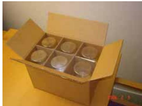
Figur 2 Standardgods bestående av polystyrenmuggar i wellpappkartong. Till vänster det standardgods som används vid sprinklerprovningar. Till höger det standardgods som användes i detta projekt.
