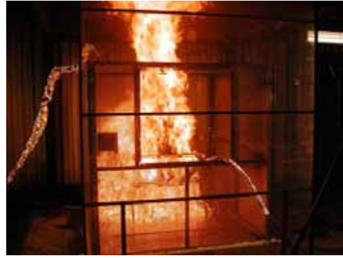
Figur 10 Varor med samma klassning som uppvisar helt olika brandbeteende. Till vänster visas branden i trälim och till höger i avfettningsmedel. Bägge produkterna är klassade som brandfarlig vara och är förpackade i samma typ av plastflaska.
