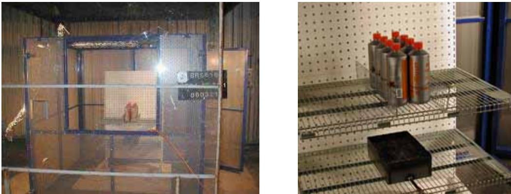
Figur 3 Försöksuppställning vid testserie 1. I detta fall med åtta flaskor avfettningsmedel. Till vänster en överblicksbild av skyddsburen och till höger en närbild av den brandfarliga varan, hyllplan samt gasolbrännare.
