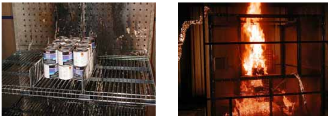
Figur 12 Hammarlack i plåtburkar. Till vänster visas försöksuppställningen före försöket och till höger efter ca 7,5 minuter. Den första burken exploderade efter 6 minuter och 50 sekunder.
