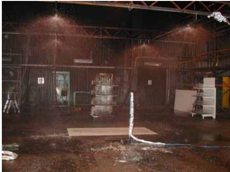
Figur 5 Provkörning av de fyra sprinklerna inför testserie 3. Sprinklerna hängde fritt i brandhallen och aktiverades vid en viss brandeffektutveckling.
