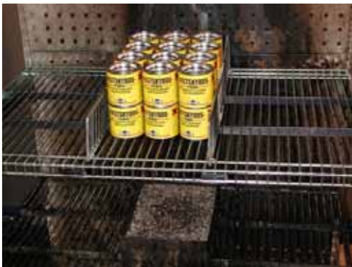
Figur 11 Rostskyddsprimer i plåtburkar. Till vänster visas försöksuppställningen före försöket och till höger efter ca 3,5 minuter. Den första burken exploderade efter 1 minuter och 28 sekunder.
