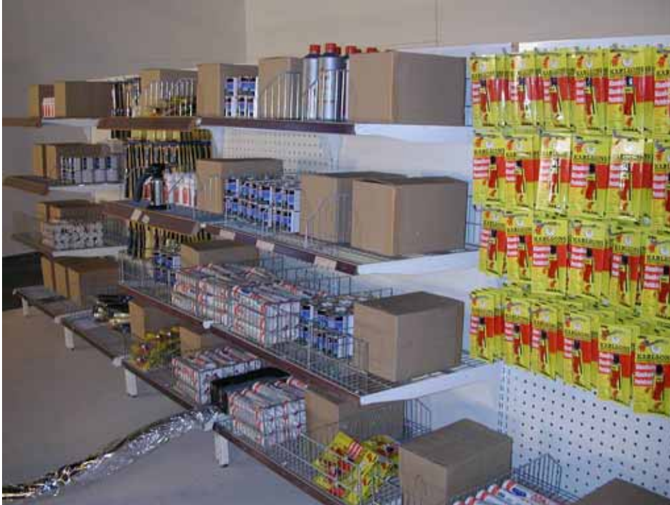
Figur 19 Fördelningen av varor i testserie 4. I de två mittersta hyllorna fanns totalt 16 enheter brandfarlig vara samt 11 enheter standardgods, dvs ca 59 % brandfarlig vara.
