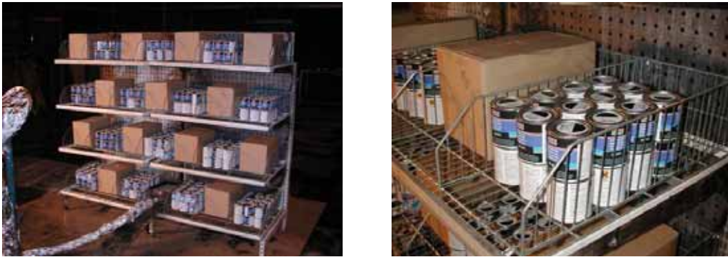
Figur 6 Exempel på försöksuppställning i testserie 3 där andelen brandfarlig vara, i detta fall Hammarlack, var 52%.
