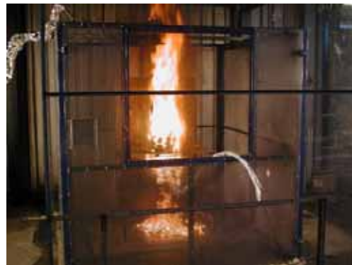
Figur 11 Rostskyddsprimer i plåtburkar. Till vänster visas försöksuppställningen före försöket och till höger efter ca 3,5 minuter. Den första burken exploderade efter 1 minuter och 28 sekunder.
