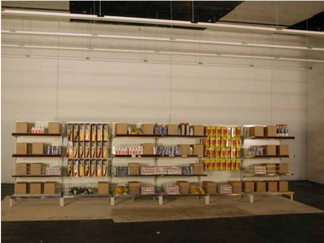
Figur 7 Försöksupställningen i testserie 4 där en verklig butiksinredning simulerades. Åtta sprinkler är monterade i taket.
