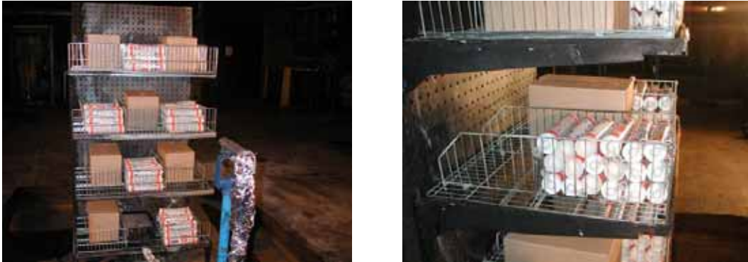
Figur 4 Försöksuppställning i testserie 2. Bilden visar uppställningen med fem enheter PL400 och sex enheter standardgods, dvs 45 % PL400.
