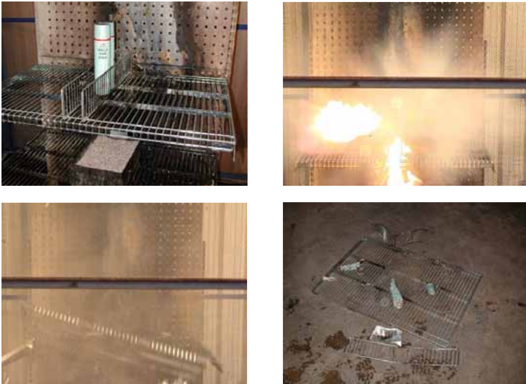
Figur 13 Explosion av hårsprayburkar. Överst till vänster visas försöksuppställningen, därefter explosionsförloppet samt det demolerade hyllplanet och sarger.
