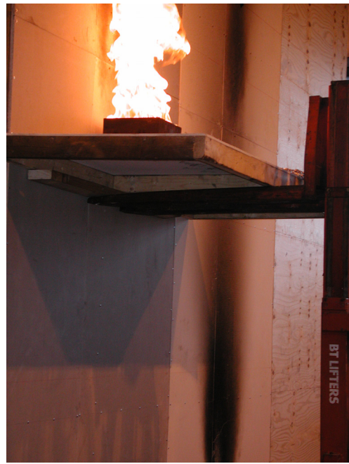
Figur 18. Simulering av envåningsbyggnad genom att lyfta upp brännaren
