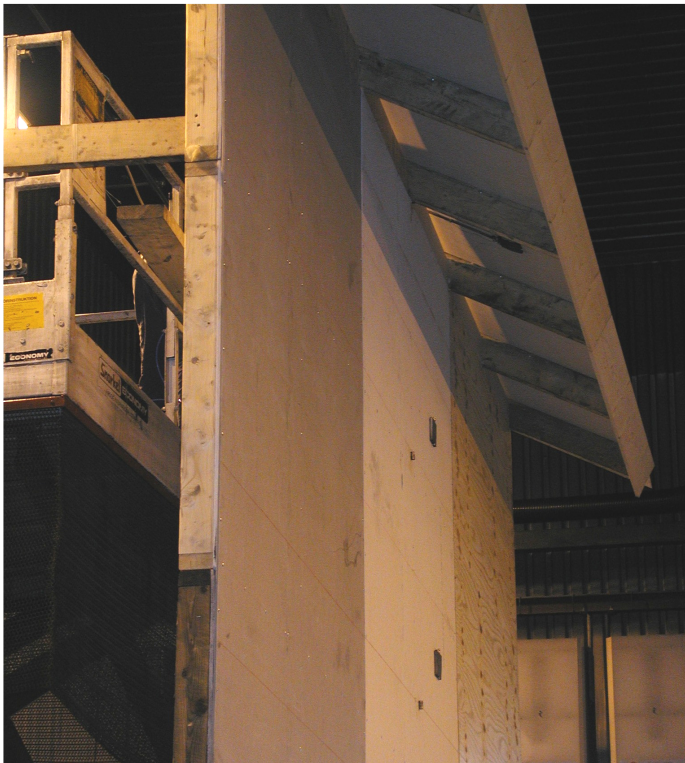
Figur 15. Försöksuppställningen där de tre olika fasaderna syns. Även platttermoelementens placering 50 cm till höger om brandens centrumlinje syns.
