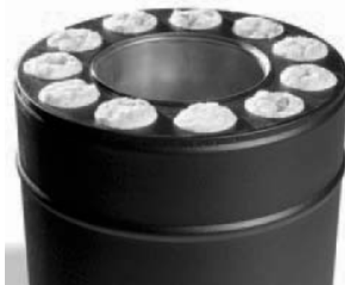
Figur 3: Skorsten Schiedel 6 Steel 60. Skorsten med innerdiameter \varnothing=150\text{mm} och 60 mm isolering. (närmast röret 30 mm aluminiumoxid och utanför detta 30 mm mineralull
