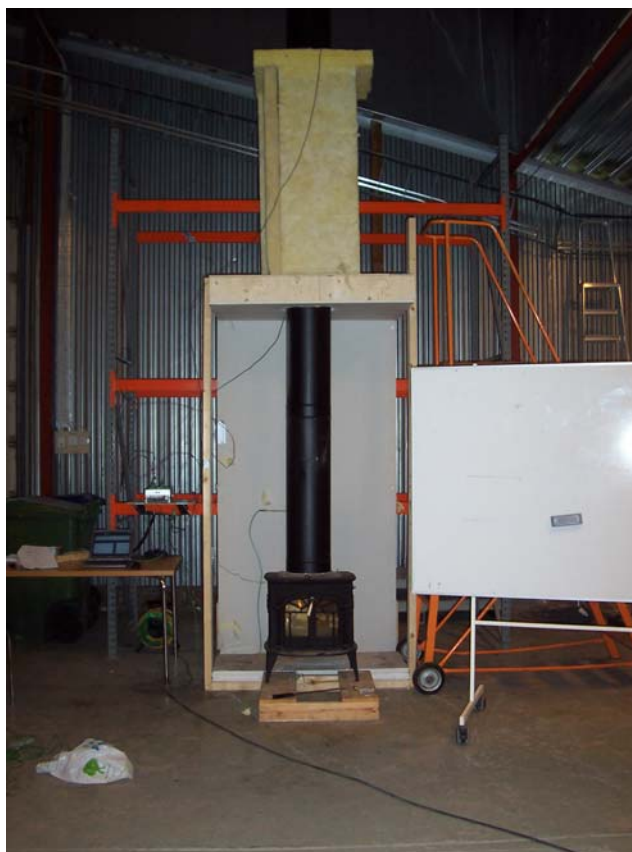
Figur 10. vid Försök 3. Skorstenen är här försedd med ett schakt av träfiberskivor och mineralullsisolering, ovanför bjälklaget.
