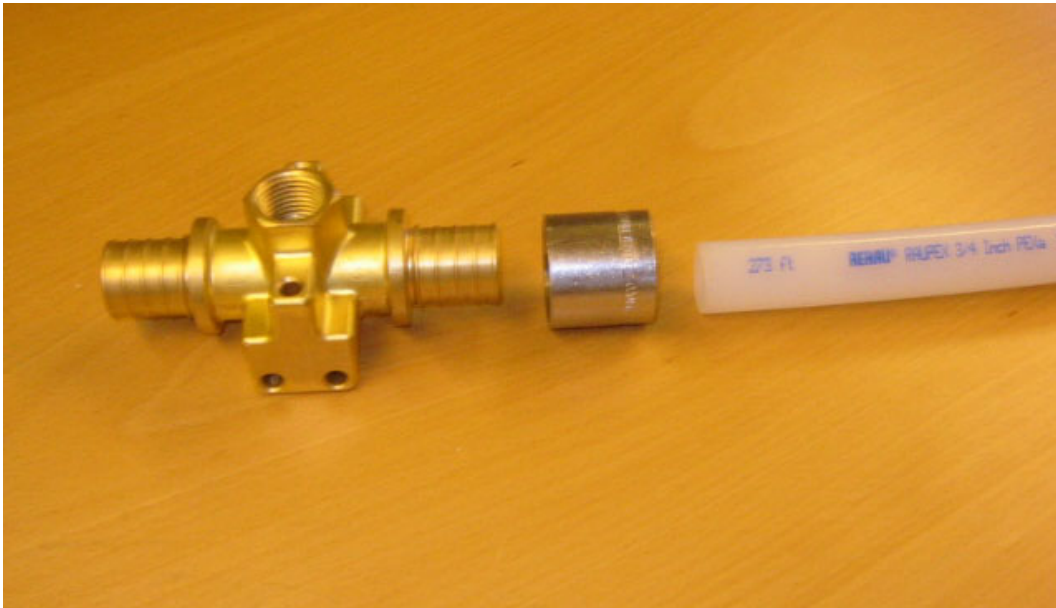
Figur 2 Fäst kropp för sprinkler för REHAU® boendesprinklersystem där 22 mm PEX-rör ansluts med en koppling av typen skjuthylsa.
