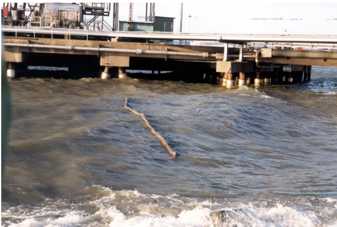
Test av sorptionslänsa i hamnbassäng
