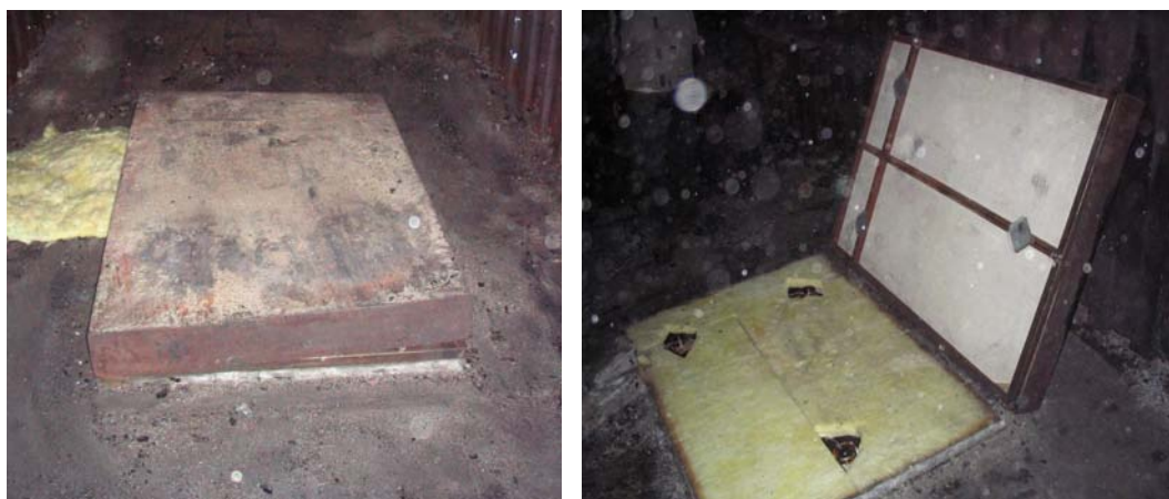
Figur 11.3 Bilderna visar den vågkonstruktion som användes för att mäta massförlusten i samband med brandförsöken i Revinge. I figuren till vänster omges vågkonstruktionen av ett skyddande plåthölje som också underlättade placeringen av bränslet på lastcellerna. Figuren till höger visar de tre lastcellerna omgivna av isolerande mineralull.
