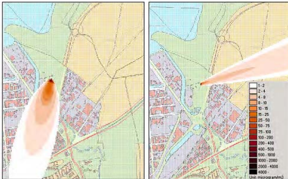
Figur 12.2 Figuren visar spridningsberäkning av halten kväveoxider från en varm rökövning på Malmö Brandkårs övningsplats Barbara. Spridningsberäkningarna gjordes vid två olika tidpunkter under 2003-02-18. Skillnaderna i de två bilderna beror på meteorologiska variationer över dygnet.
