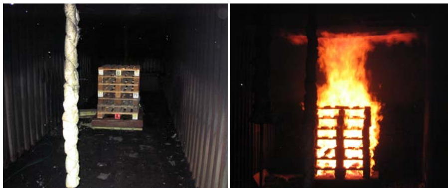
Figur 11.5 Bilderna visar det första försöket med lastpallar. Bilden till vänster visar pallarna uppställda på vågkonstruktionen. I den högra bilden visas lastpallar under fullt utvecklade brand.
