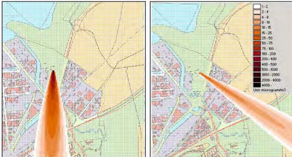
Figur 12.1 Figuren visar spridningsberäkningar av halten kväveoxider 1 meter över markhöjd från en varm rökövning på Malmö Brandkårs övningsplats Barbara i Malmö. Spridningsberäkningarna gjordes vid två olika tidpunkter under 2003-02-17. Skillnaderna i de två bilderna beror på meteorologiska variationer över dygnet.
