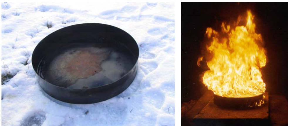
Figur 11.4 Vid försöken med de vätskeformiga bränslena användes ett fat med diametern 500 mm och höjden 100 mm. Fatets totala volym var cirka 20 liter. Vid försöken fylldes halva fatet med vatten. Resterande del fylldes sedan med bränsle.
