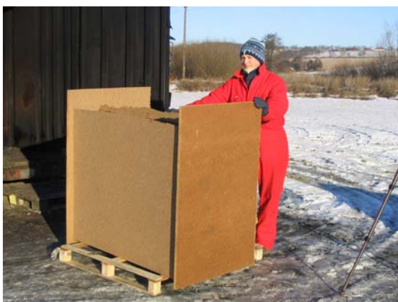
Figur 11.6 Bilden visar hur tretexskivorna konstruerades så att de skulle passa vågen inne i containern. Konstruktionen var nödvändig för att skivorna skulle hålla sig kvar på vågen så länge som möjligt under brandförloppet. Spånskivorna var konstruerade på samma sätt.
