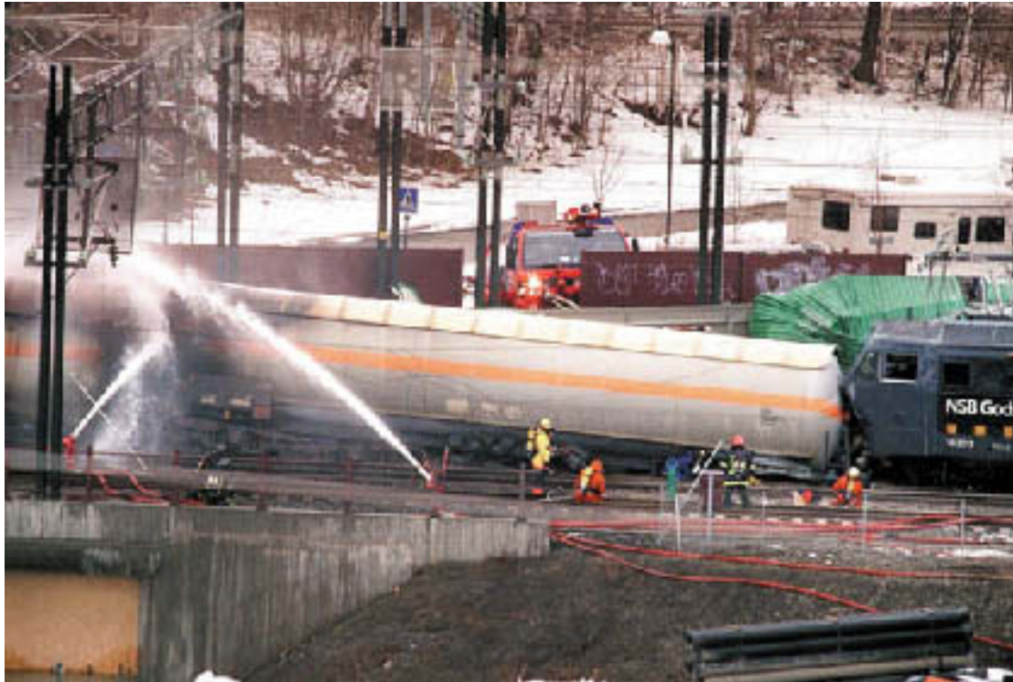
Figur 9.2 Den forreste tanken ble stående med helning fremover på ca. fem grader etter kollisjonen
