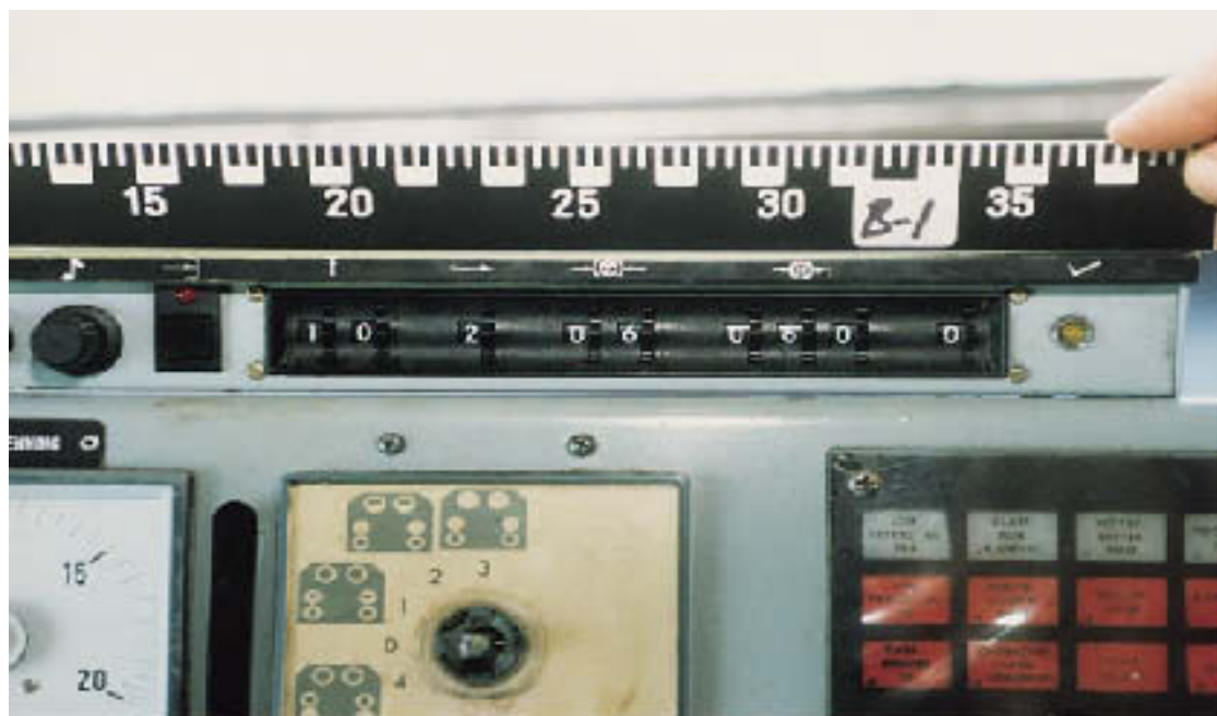
Figur 3.7 ATC-panelet i førerrommet på lokomotivet i tog 5781. Innstillingen betyr fra venstre: 10 angir maksimal hastighet til 100 km/t, 2 betyr at en toglangde på 200 m, 06 betyr 6 sekunders bremsetilsettingstid og 060 betyr 0,60 m/s 2 maksimal retardasjon
