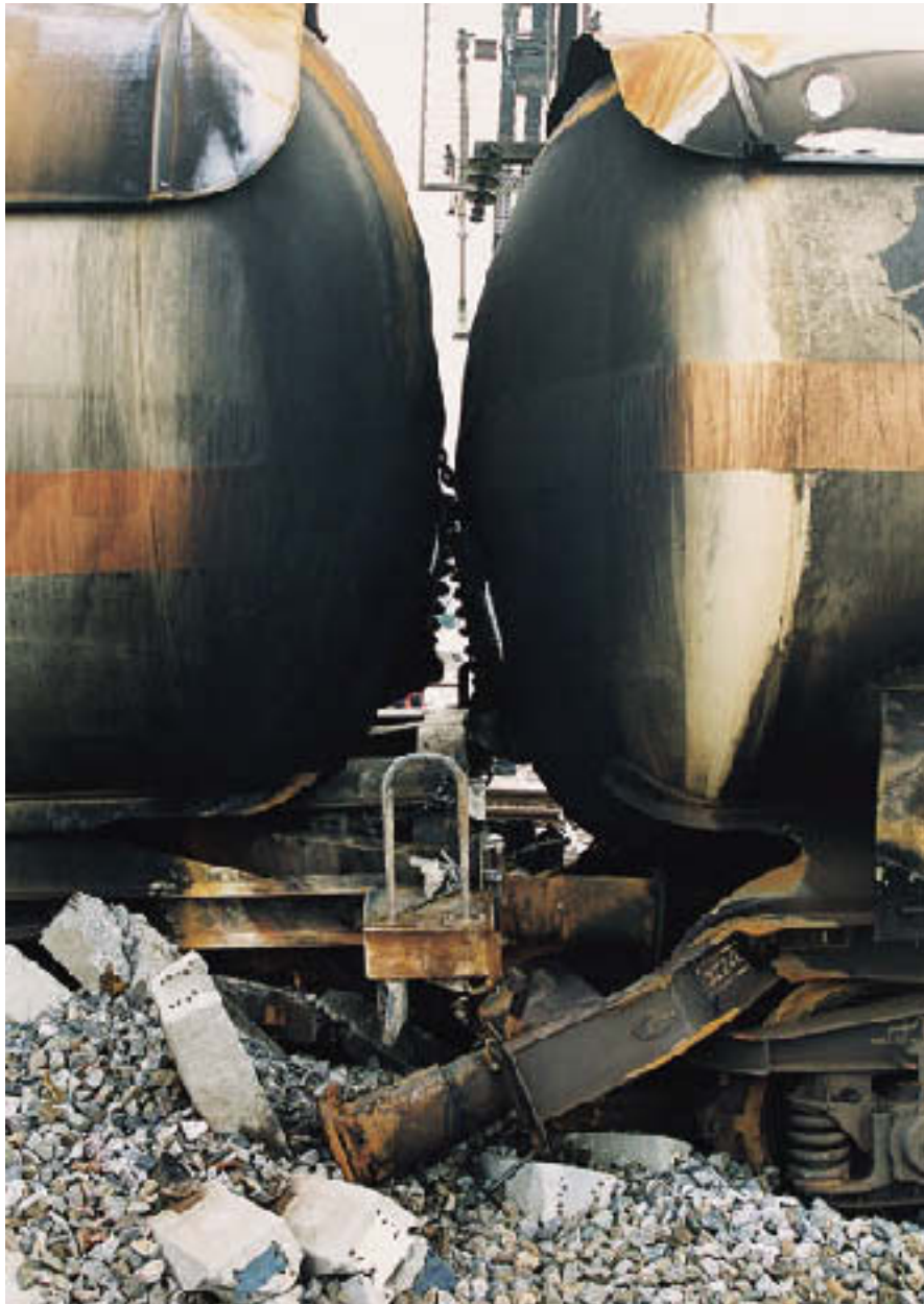
Figur 3.13 Berøringspunktet mellom vogn 1 og 2 i tog 5781. Mannlokkene og boltene ses midt på bildet Kilde: Romerike politidistrikt
