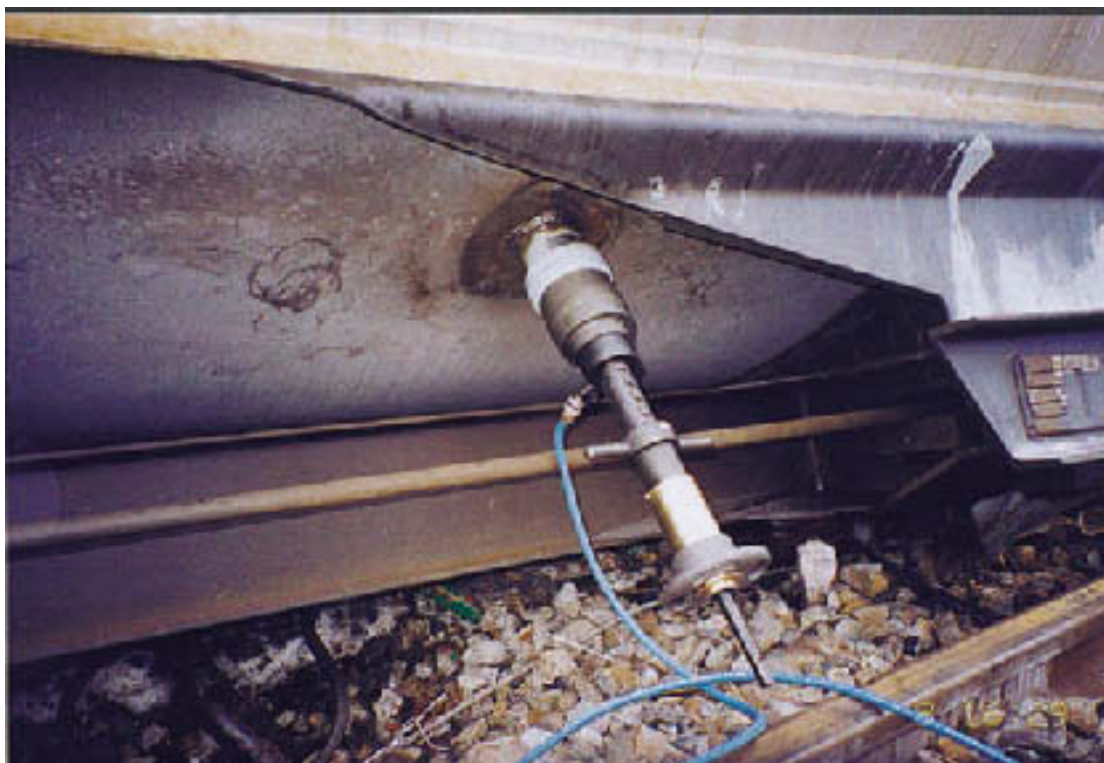
Figur 3.20 Ventil som ble sveiset på for å tappe propan fra tanken på vogn 1 Kilde: Romerike politidistrikt
