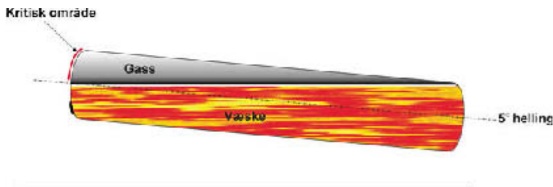
Figur 9.3 Skissen viser at tankens helning medførte at et stort område av den branneeksponerte endebunnen i tank 1 var over væsknivået
