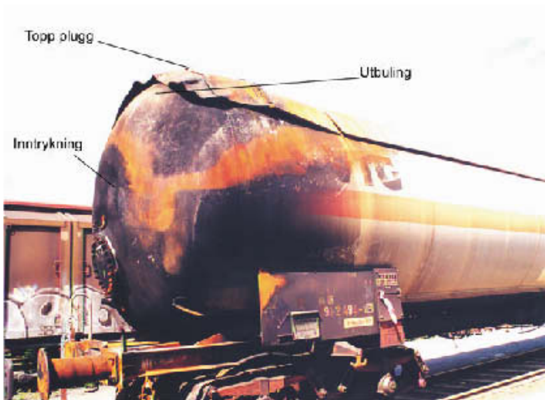
Figur 6.4 Bakre del av gasstanken på vogn 1 etter brannen. Inntrykkingen over mannhullet og utbulingen på tankens øvre del er angitt. Videre pekes på toppluggens plassering Kilde: DnV
