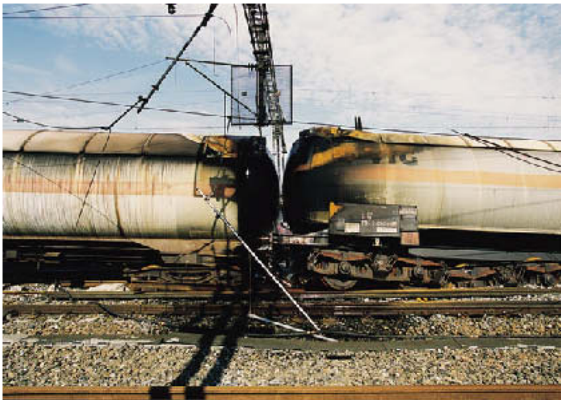
Figur 3.12 Brannområdet mellom vogn 1 og 2 i tog 5781 etter slokking Kilde: Romerike politidistrikt
