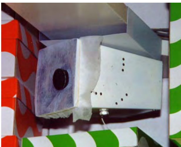
Figur 10. Detaljbild på videokamera i plåtlåda.
