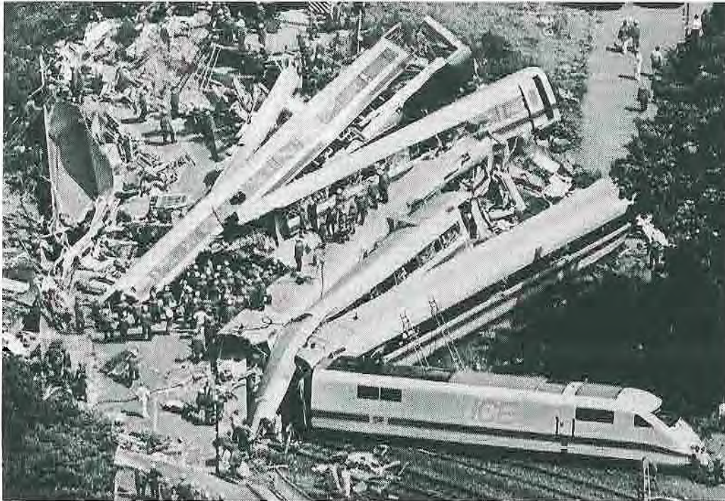
Bild 2. Tåget spårade ur och sex av de tretton vagnarna passerade aldrig under bron utan körde rakt in i viadukten. Två av dem fick bron över sig och övriga vagnar lade sig ovanpå varandra.
