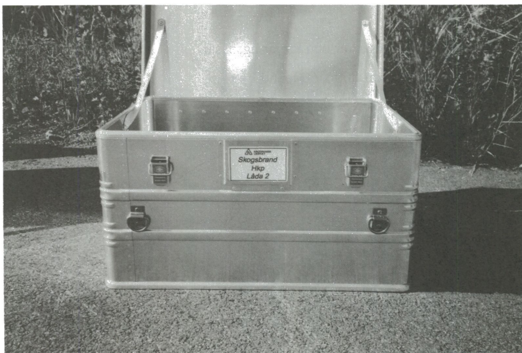
Bild 2. Låda försedd med öglor för vinschning. Utbytbar märkningsetikett. I detta fall saknas viktangivelse - kommer att stå på etiketten
