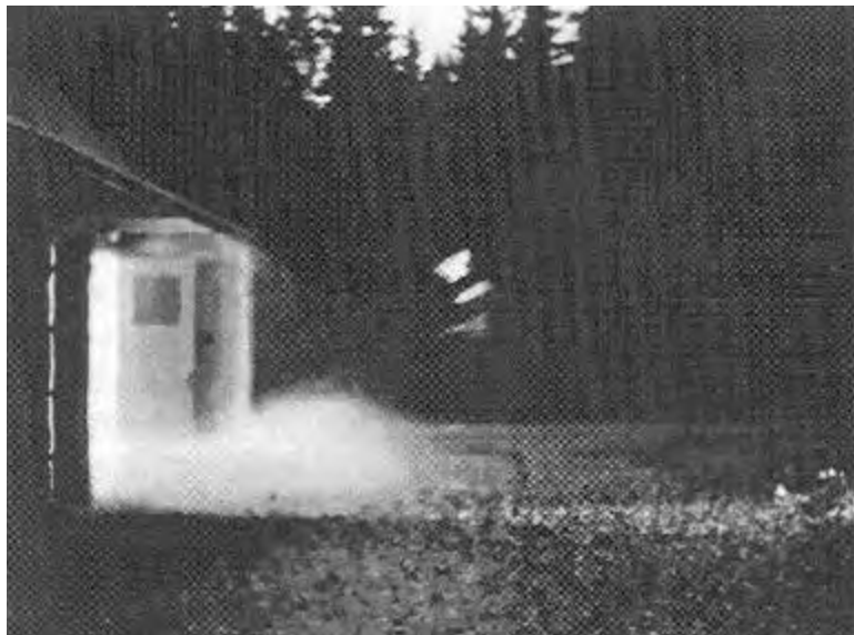
Figur 14. Explosion av 0,5 kg acetylen inne i en lokal med volym 165 \text{ m}^3 och avlastningsarea 4 \text{ m}^2 .
